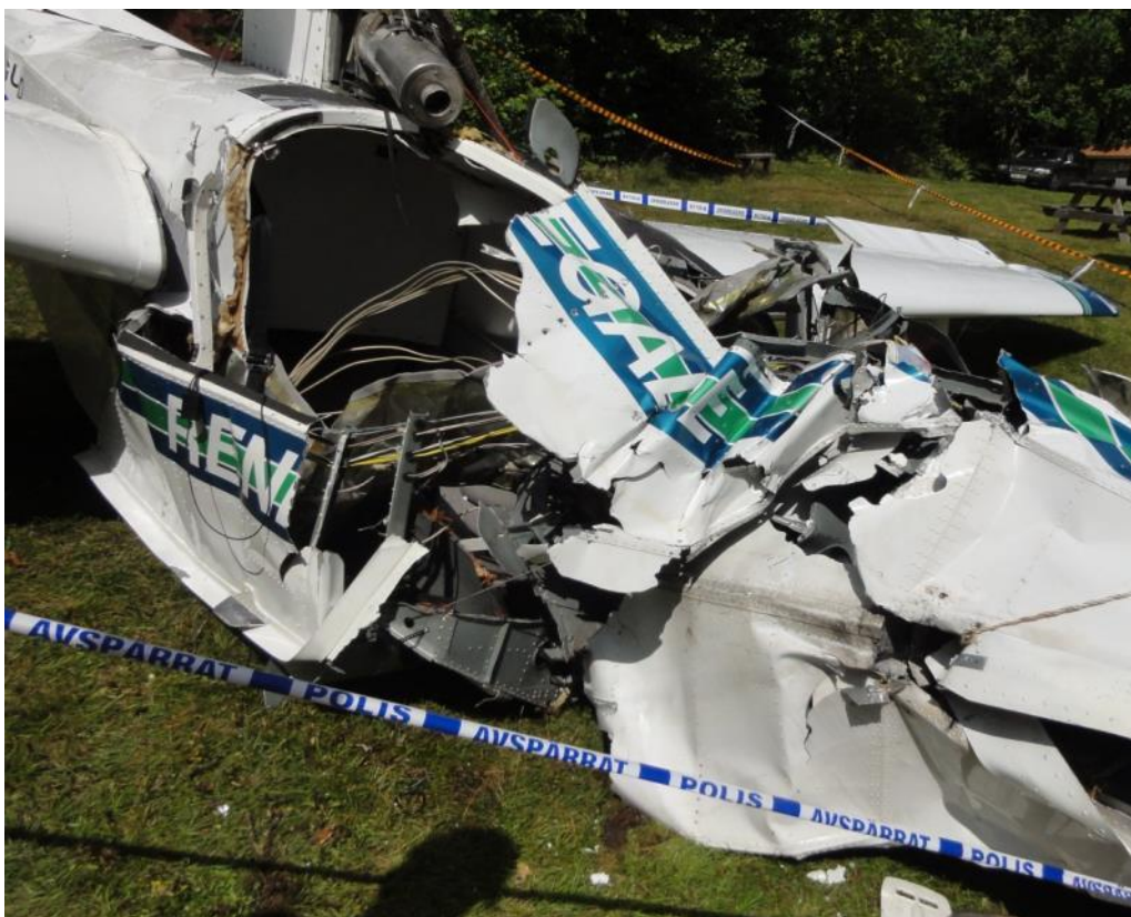
Fig. 4. Nosen var avbruten och ingen struktur fanns kvar vid den högra framsitsen.
