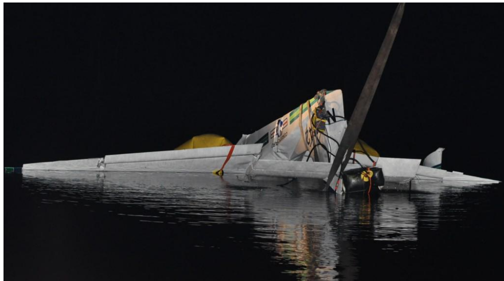
Fig. 7. Flygplanet ligger upp och ned i vattenytan efter att ha lyfts med uppblåsbara lyftkuddar. Foto: Göran Johansson, Sydostnyheterna.
