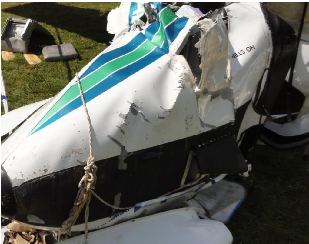
Fig. 6. Nosens överdel hade kompressionsveck.
