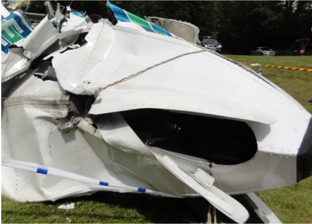
Fig. 5. Nosens undersida med mjuka intryckningar.
