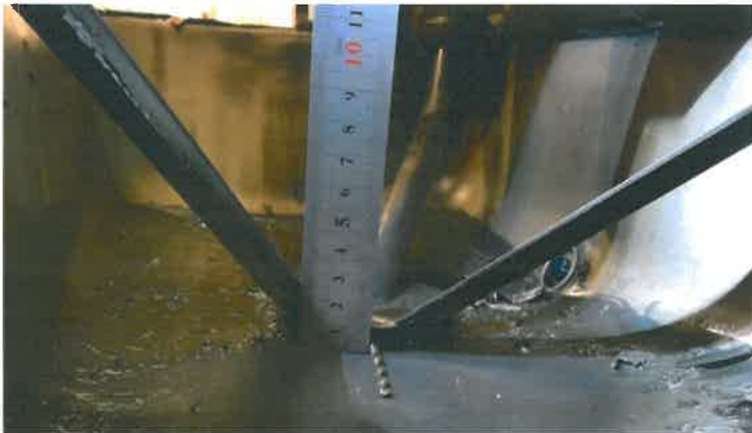
Figur 7. Bild på oljesilens placering. Notera att oljeavtappningen är placerad på sidan ungefär 15 mm ovanför trågbotten. Borret på bilden är placerad som dimensionsreferens och har en diameter av 3,5 mm.
