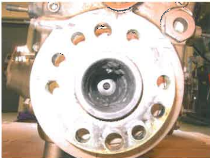
Figur 10. Bild visandes avlagringar inuti vevaxelns framände. Bilden är tagen efter det av att delar av avlagringarna avlägsnats.
