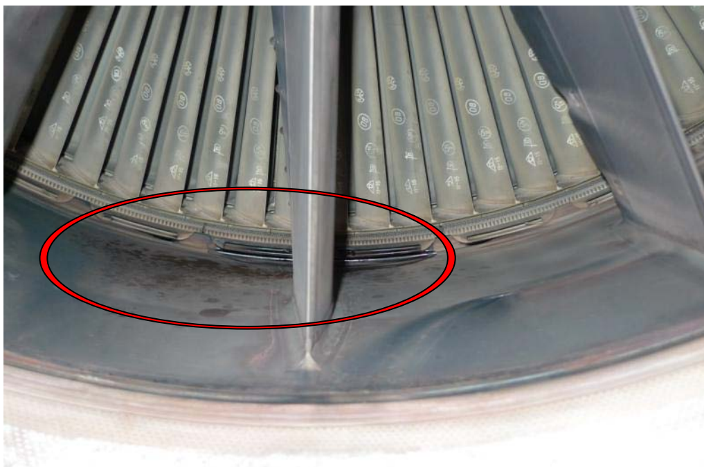
Fig.2. Motor nr 1: Område vid bakre utlopp med spår av förbrända rester av olja eller bränsle. Foto SHK.
