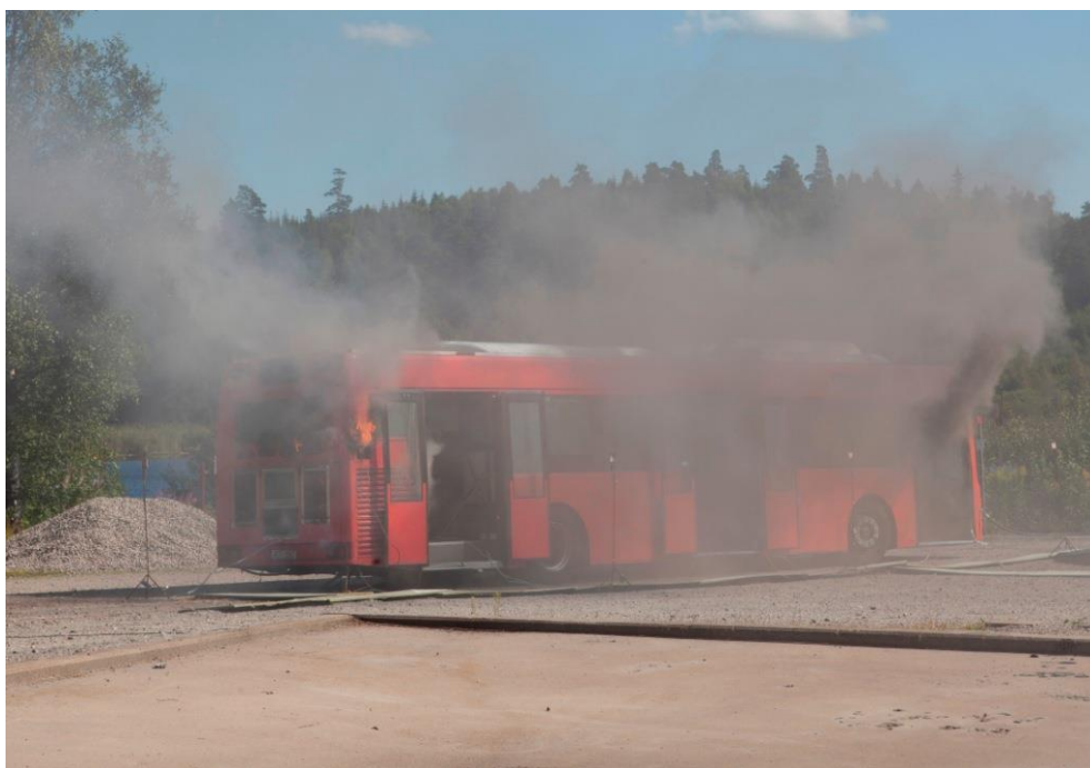
Fig. 19 Branden vid tiden 7 minuter efter antändning av gasläckaget.
