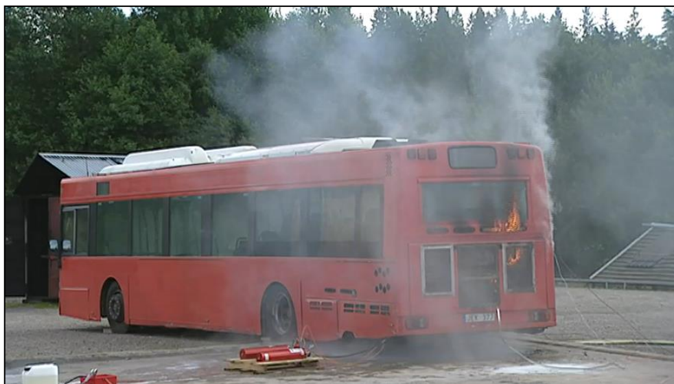
Fig. 20 Foto taget under tiden då släcksystemet aktiverats.
