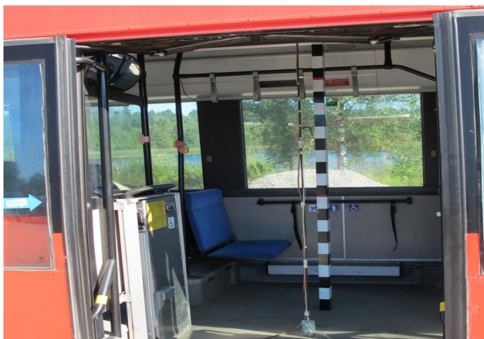
Fig. 15 Utrustning för mätning av temperatur och rökgaslagret i bussen.
