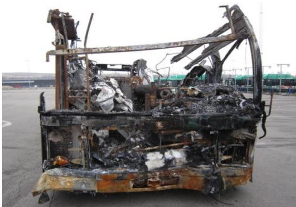
Fig. 10 Fronten på VOLVO-bussen med omfattande skador på stötfångare och fackverk.
