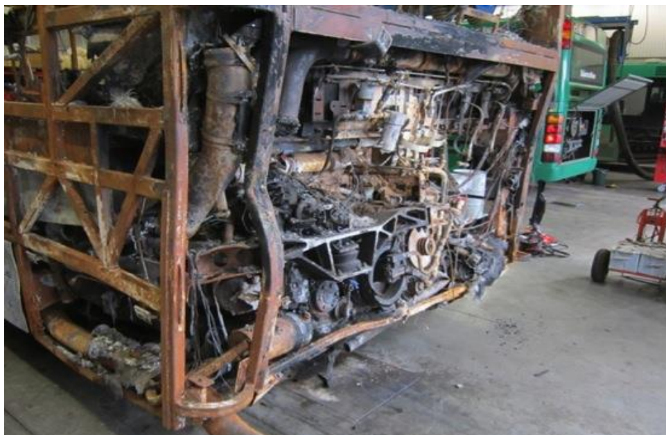
Fig. 11 Bakpartiet på MAN-bussen med skador på motorbalken och behållare för styrservoolja och bränslefilter.
