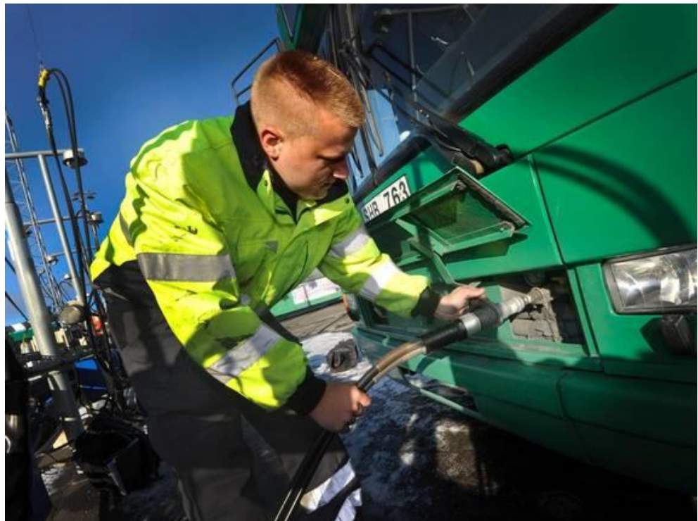
Fig. 7 Tankventilen som sitter i fronten på VOLVO-bussen.
