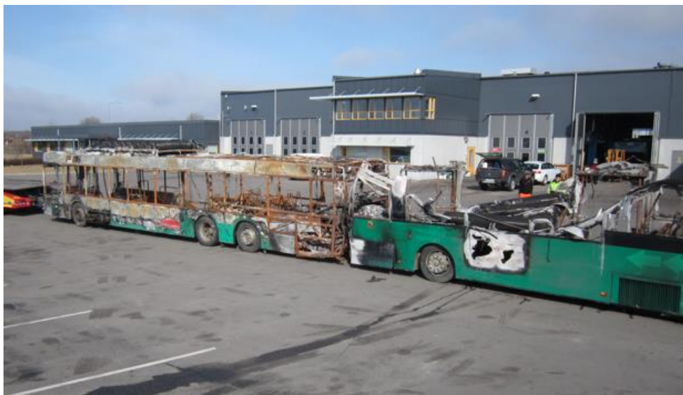
Fig. 9 Rekonstruktion av kollisionen som visade en ren träff hörna till hörna i front och bakdel.
