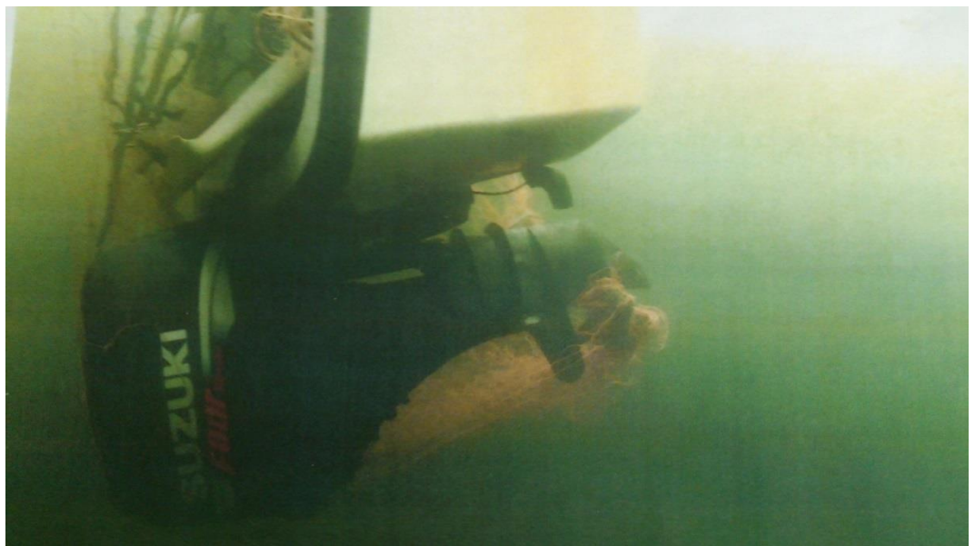
Fig 6. Undervattensfoto med GELIA i lodrätt läge med laxnätet fast i propellern. Foto: Polisen.
