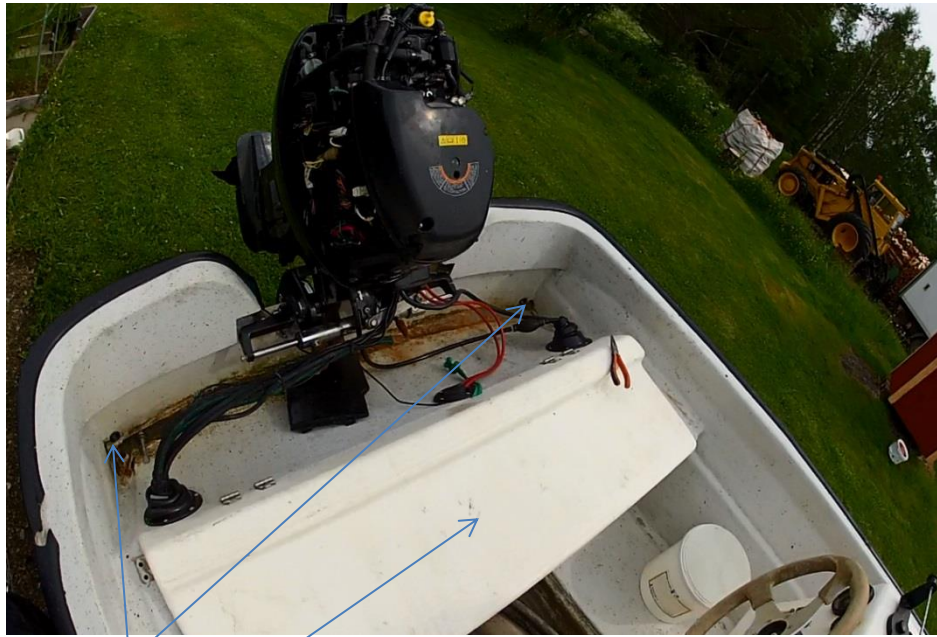
Fig 5. Självbläns och aktertoft kommunicerande med kölsvinet.
