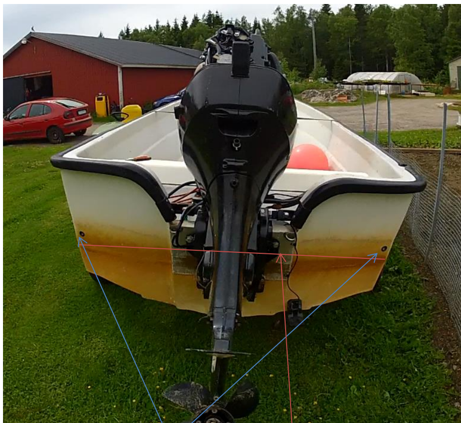
Fig 4. Låg akterspegel med självläns och troligt djupgående.
