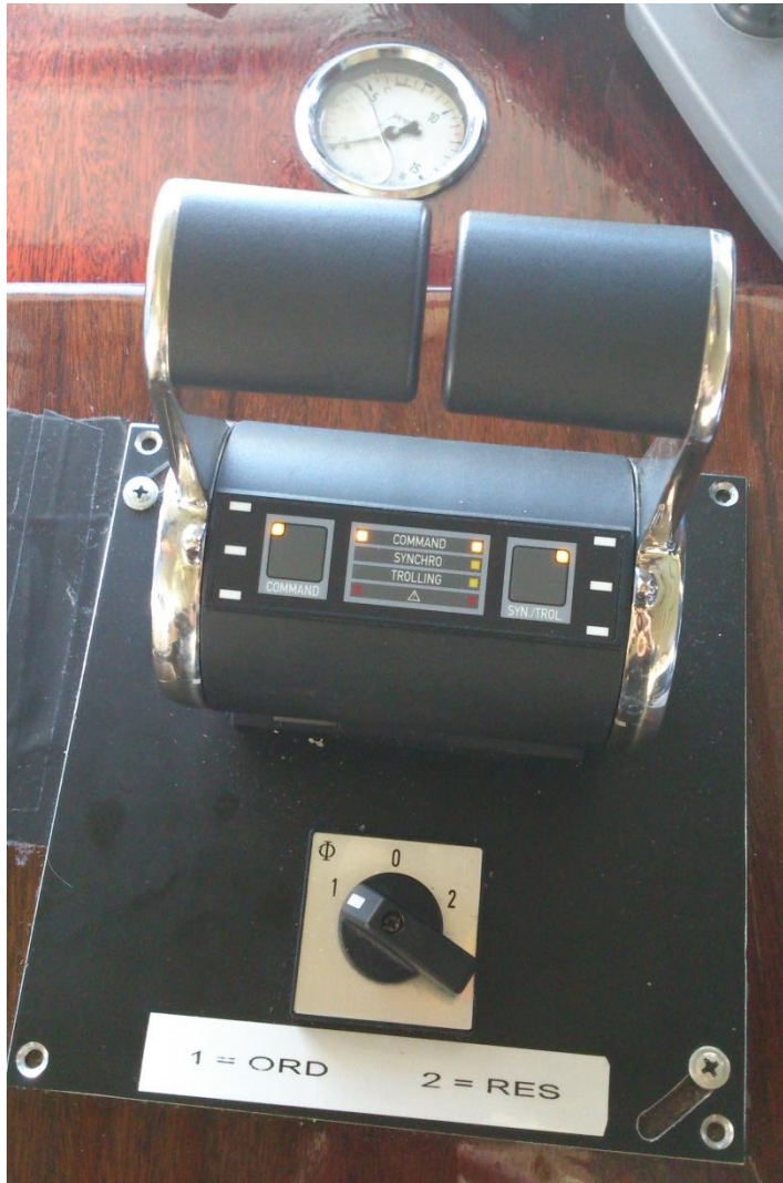
Figur 8. Manöverspakar för framdrift. Spakarna sitter på var sida om stativet och är på bilden i friläge. På ovensidan av stativet sitter på var sida en tryckknapp med lysdiod som används för att aktivera manöverspakarna för respektive maskin. Vid denna händelse kan man likna det vid en reset-funktion. Strömställaren i mitten av nedre delen av bilden reglerar strömförsörjningen.
