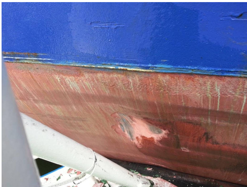
Figur 5. Intryckning i STENA GERMANICAs skrov. Bild: Transportstyrelsen
