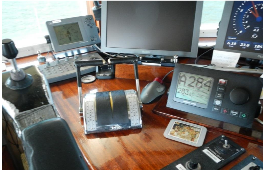
Figur 10. Anordning för det pneumatiska kontrollsystemet samt automatstyrningssystemet på ÄLV-SNABBEN 4.
