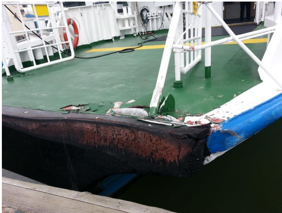
Figur 4. Skrovskador på ÄLV-SNABBEN 5. Bild: Transportstyrelsen
