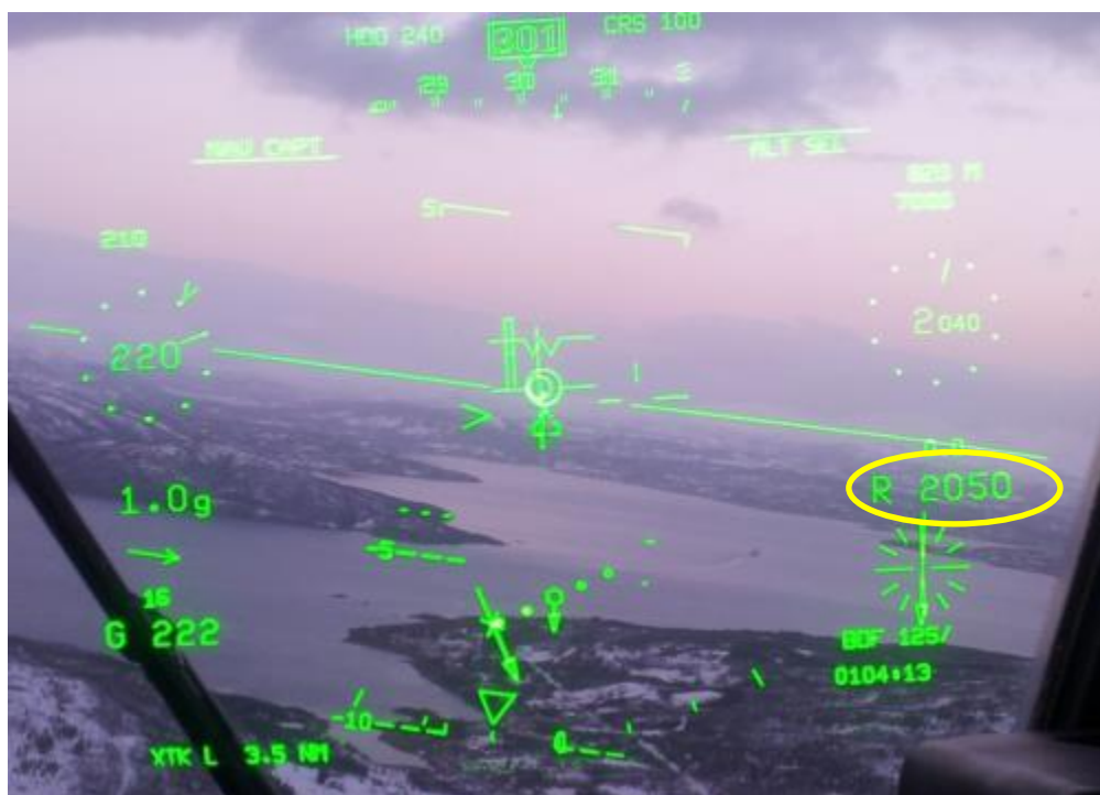
Fig. 9. Bilde på Head Up Display, HUD, hvor radarhøyden har blitt innringet med gult.. (Bilde: det norsk Luftforsvar.)
