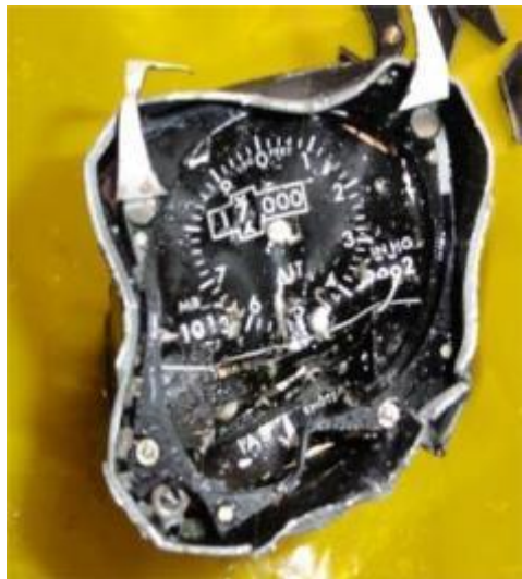
Fig. 35. Reserveinstrument for fart og høyde. (Foto: SHK)
