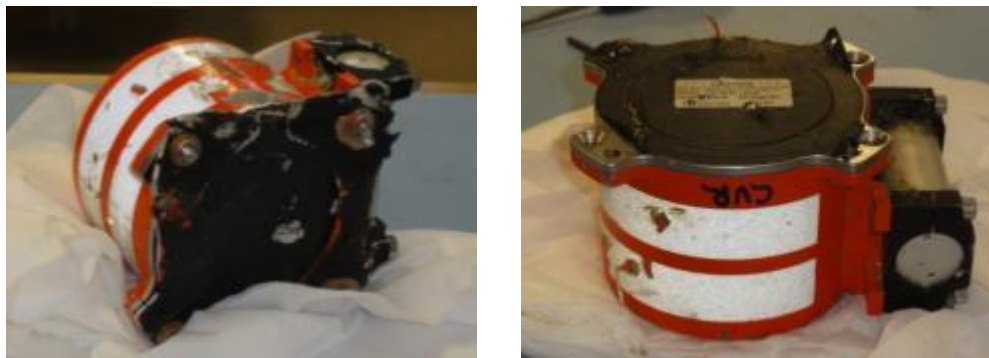
Fig. 23-24. Minneenhetene fra DFDR og CVR var kollisjonssikre. (Bild SHK.).
