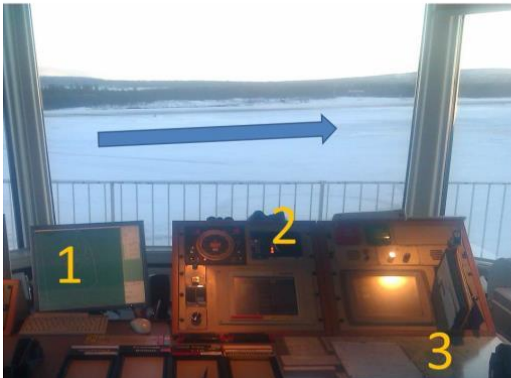
Fig. 18. Flygelederens arbeidsposisjon i Kirunatornet. Tallene markerer følgende utrustning: 1=radarskjerm, 2=peil, 3=kart. Banens plassering markeres av den horisontale pil, viss retning er 03/21. Kebnekaise var på hendelsestidspunktet ikke markert på radarskjermen.
