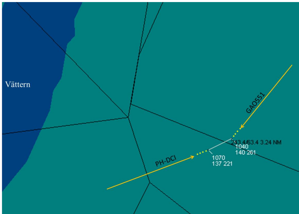
Fig. 1. Radarspår med minsta vertikala avstånd 300 fot vid ett horisontellt avstånd på 3,24 nm.
