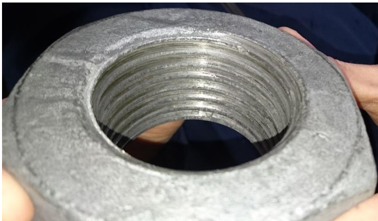
Figur 48. Muttar med mycket små mängder smörjmedel i gängan.
