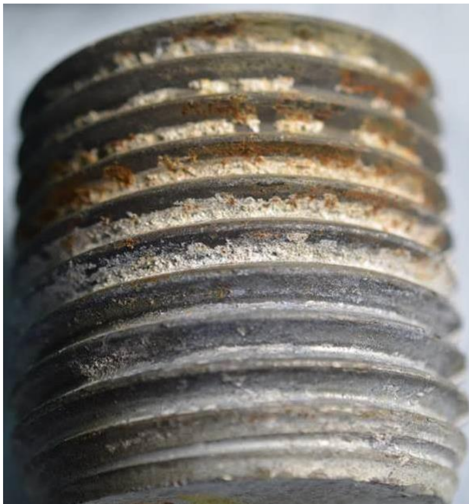
Figur 18. Gängor på skruv 1, röd- och vitrost.
