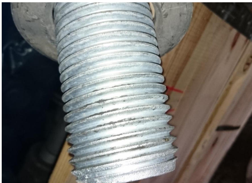
Figur 50. Smörjmedel i små sjok på skruvens gänga.
