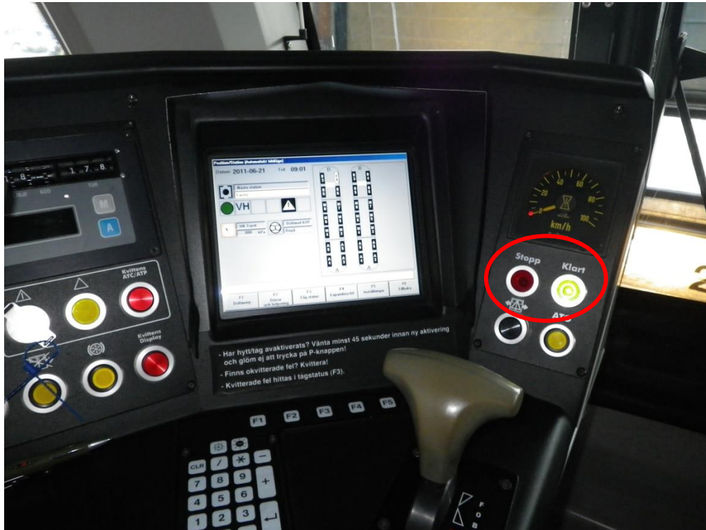
Figur 5. Förarhytt i C20 med signal för "Stopp" och "Klart" (röd inringning) samt informations-skärm.
