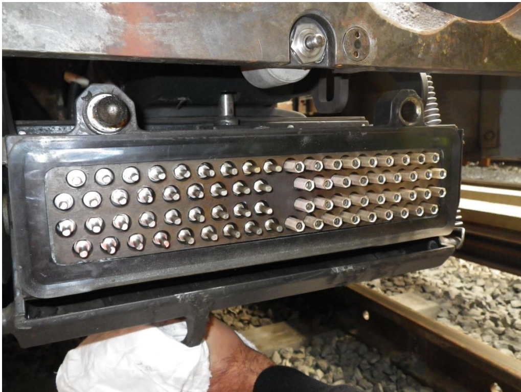
Figur 3. Lågeffektdon på automatkopplet.
