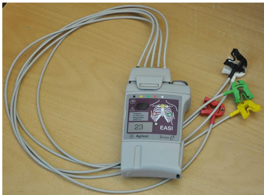
Fig. 6 Sändare för övervakning av EKG med telemetri.
