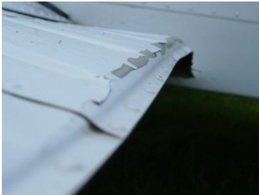
Fig. 8 Vänster bakkantklaff var kraftigt deformerad. På undersidan av klaffen syntes märken från träden som visade att klaffen var utfälld 25 grader eller mer vid kontakten med träden.
