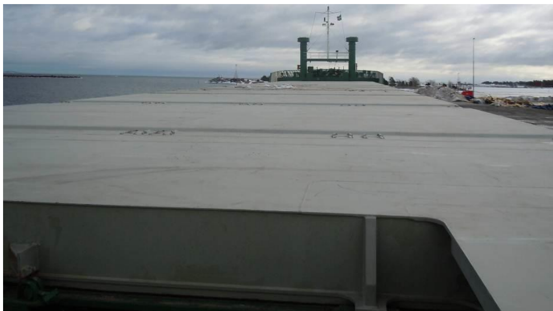
Figur 3. Phantoms lastlucka med de infällda containerfästena.
