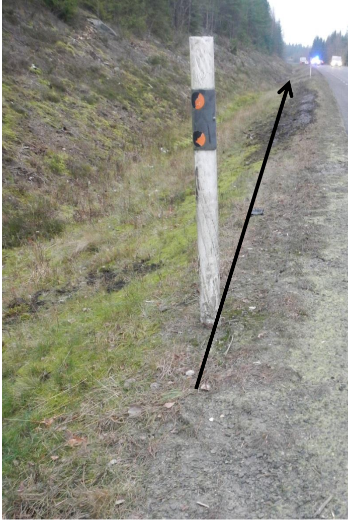
Figur 7 – Avåkningsposition som markeras med basen på den svarta pilen. Hjulspår finns strax före vägstolpen på stödremsan. Stolpen uppvisade tecken på överkörning. Pilens riktning visar på bussens färdriktning.
