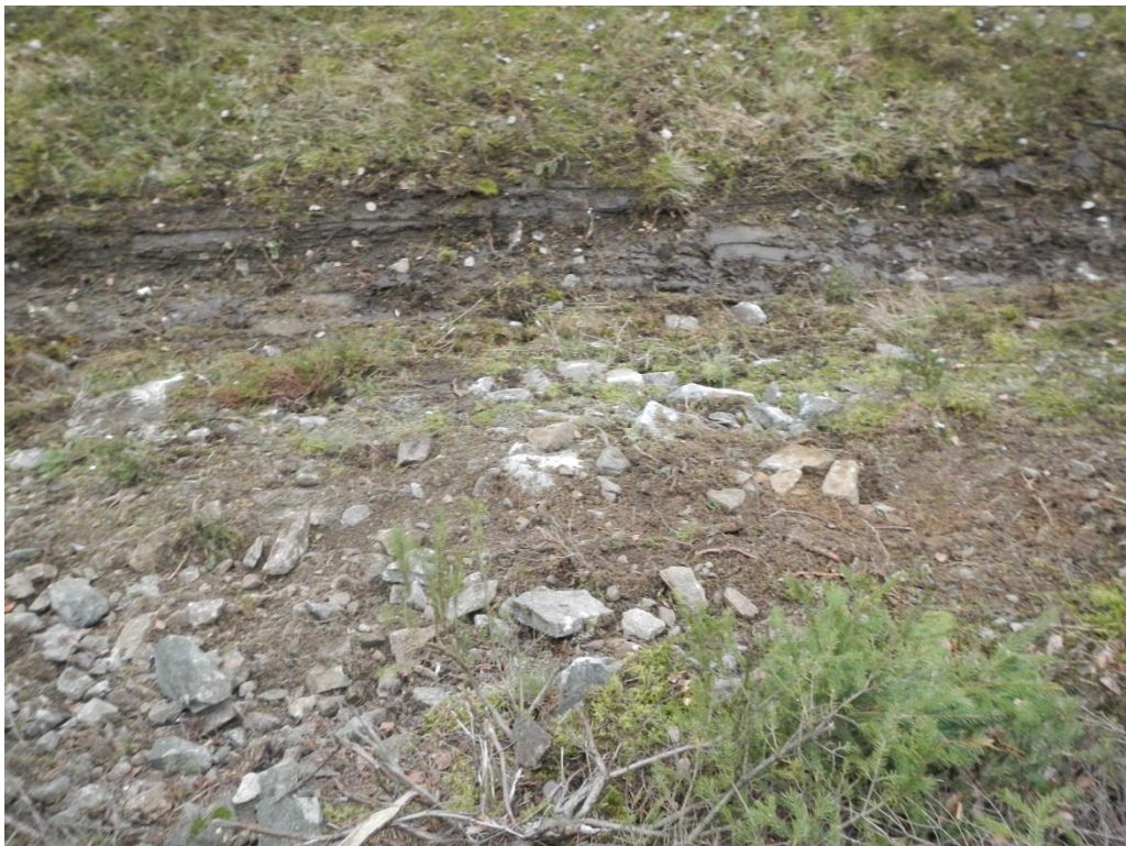
Figur 9 – I bildens centrum finns en dold större sten i slätten, samt mindre stenar med islags- och skrapmärken. Bilden är tagen ståendes i ytterslätten vänd mot dikesbotten.
