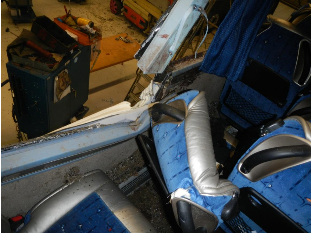
Figur 18 - Ryggstödet på plats 34 hade skjutit sig 45 grader medsols.
