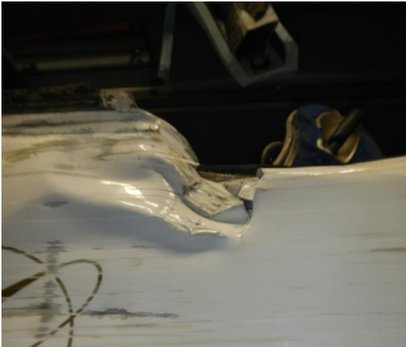
Figur 14 - Deformation vid E-stolpe, vid plats 34 och 36.
