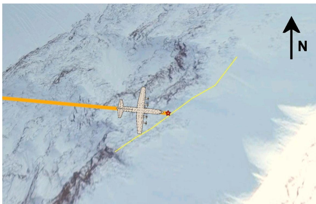
Fig. 10: Bildmontage, med islagspunkten sedd uppifrån. Höjdkurvan vid islagspunkten är utmärkt med gul linje, och flygplanets inflygning med bred orange linje. (Baserad på satellitbild från Google Earth.)
