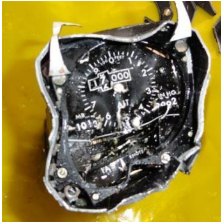
Fig. 21: Reservinstrument för höjd och fart. (Foto: SHK)
