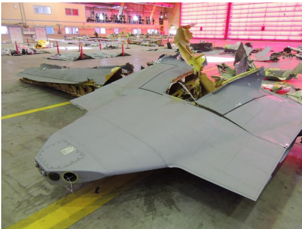
Fig. 13: Några av de större vrakdelarna i hangaren. Delar av stjärtpartiet i förgrunden. (Foto: SHK.)
