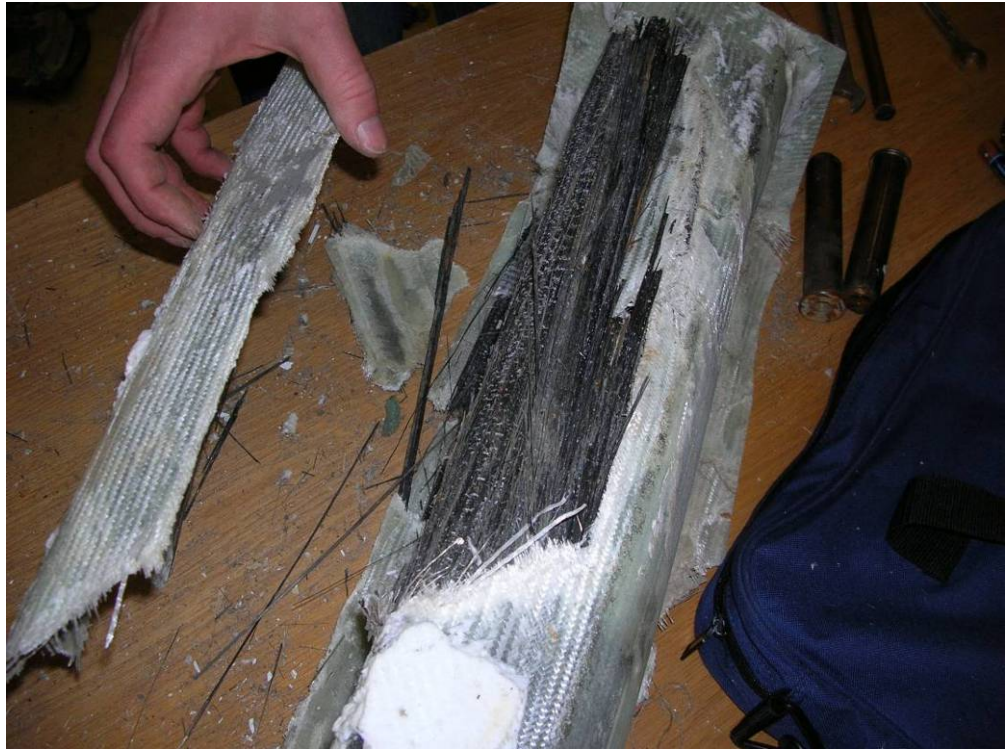
Fig 8. Den främre vingbalken. Foto SHK.
