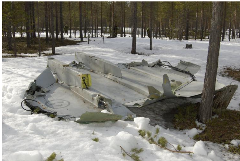
Bild 1. Flygplanet sönderdelades kraftigt. Bilden visar höger vinge som var den största vrakdelen på haveriplatsen
