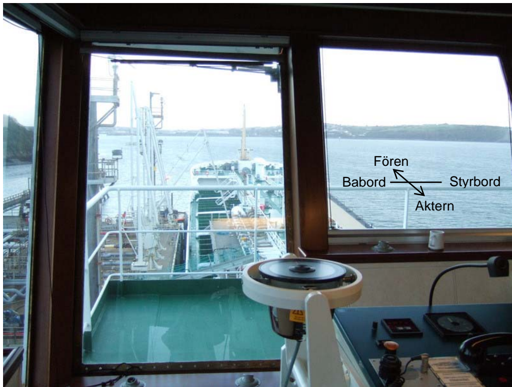
Fig 12. Bild tagen framåt från bryggans babordskonsol, påvisar skymd sikt
