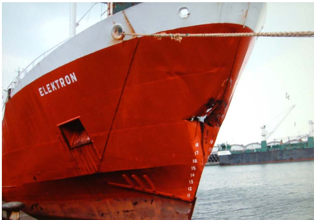
Fig 16. Skada på Elektrons bog från kontakten med slussportarna
