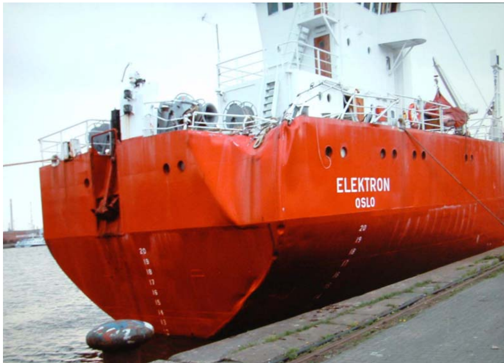
Fig 15. Skada på Elektrons akter från kollision med Bro Sinceros bog
