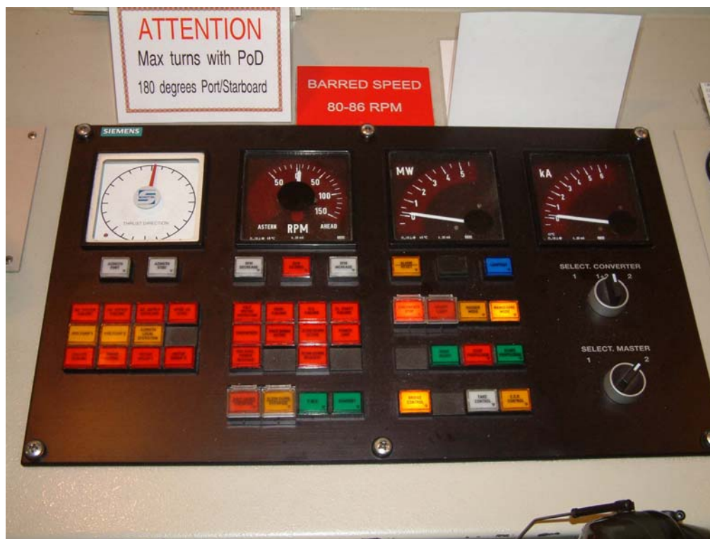
Fig 14b. Manöverkonsolen för ECR, närbild på podreglagen
