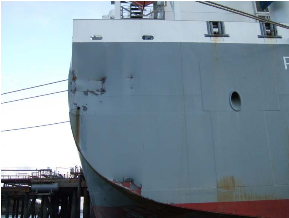
Fig 5a. Skada på Prosperos akter från pirens dykdalber, akterifrån
