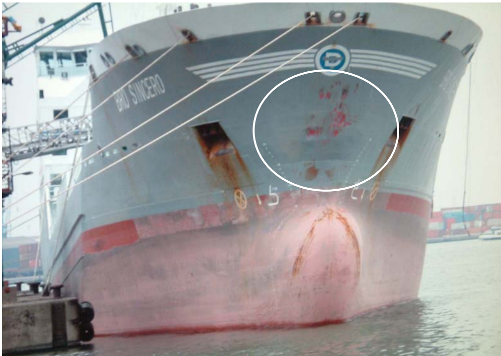
Fig 17. Skada på Bro Sinceros bog från kollisionen med Elektrons akter
