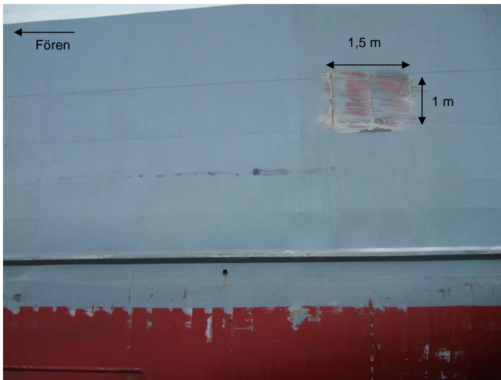
Fig 2. Skada på babords låring på Prospero från pirens hörn
