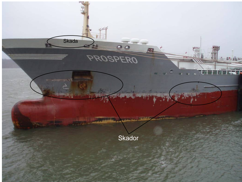
Fig 3. Prosperos bog, bild på skada från pir och ställning
