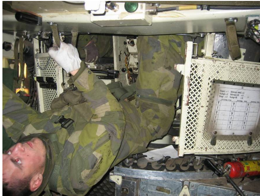
Bild 9. Skytten utrymmer bakåt genom stridsutrymmet. Notera den vassa kanten vid höger överarm
