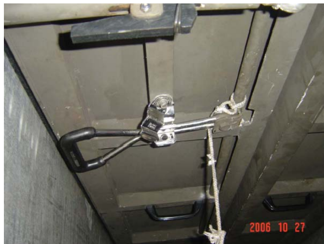
Fig. 8 Oskadad stävlucka med spanjolethandtag i låst läge. Säkring och karbinhake ej i läge.
