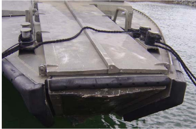
Fig. 6 Oskadad båt sett framifrån med stävport och stävluckor stängda.
