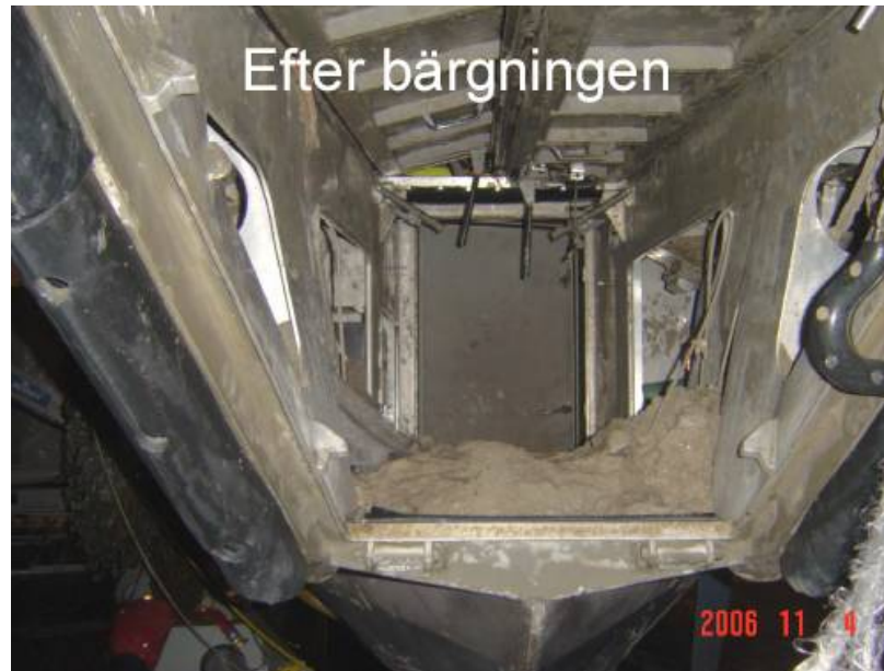
Fig. 14 Förpiken fylld med lera efter bärgningen.
