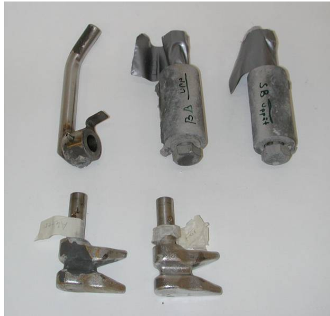
Fig. 24 De undersökta detaljerna. Övre raden från vänster visar handtag och gångjärn. Nedre raden är låsgafflar.
