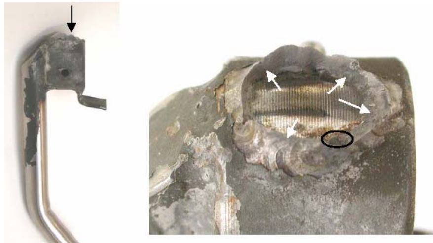
Fig. 30 Dörrhandtag med avbruten (saknad) låstapp. Delförstoringen visar brottytan. Kraften mot tappen var riktad mot höger på bilden.
