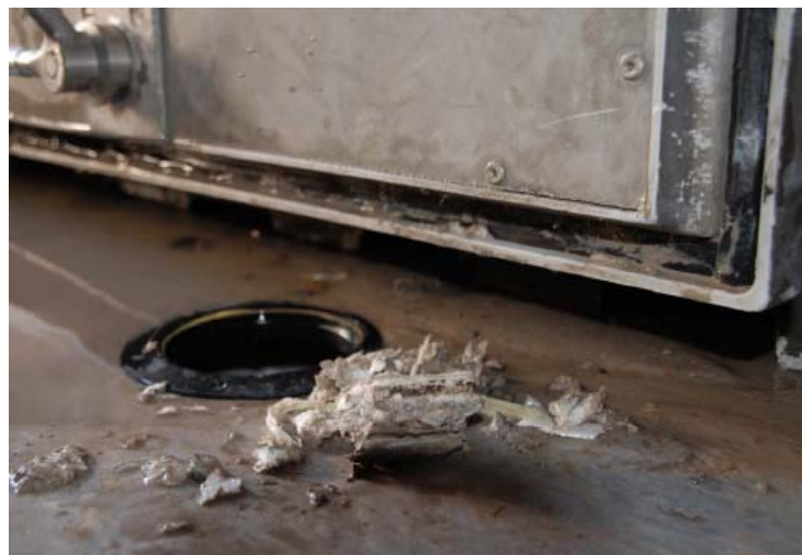
Fig. 16 Pappersträng i packningsränna före och efter borttagande.
