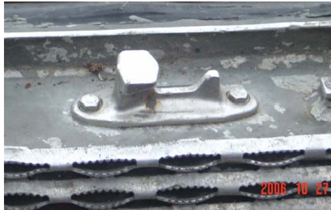
Fig. 9 Förligt låsbeslag för spanjolettlåssets gaffel.
