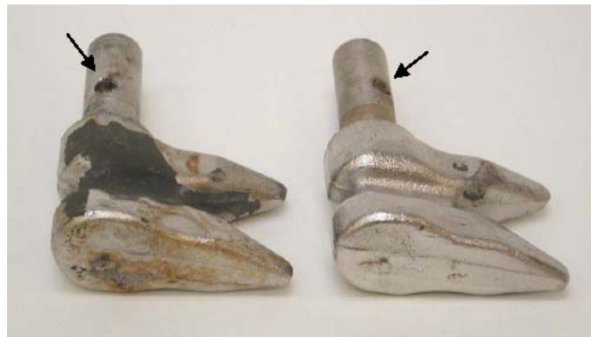
Fig. 25 Aktergaffel (vänster) och förgaffel (höger). Rörsprintarna har pilmarkerats.
