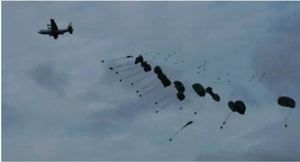
Fig. 6: CDS-fällning av 16 kollin från TP84. Det fjärde kollits fallskärm utvecklades inte, en s.k. streamer.
