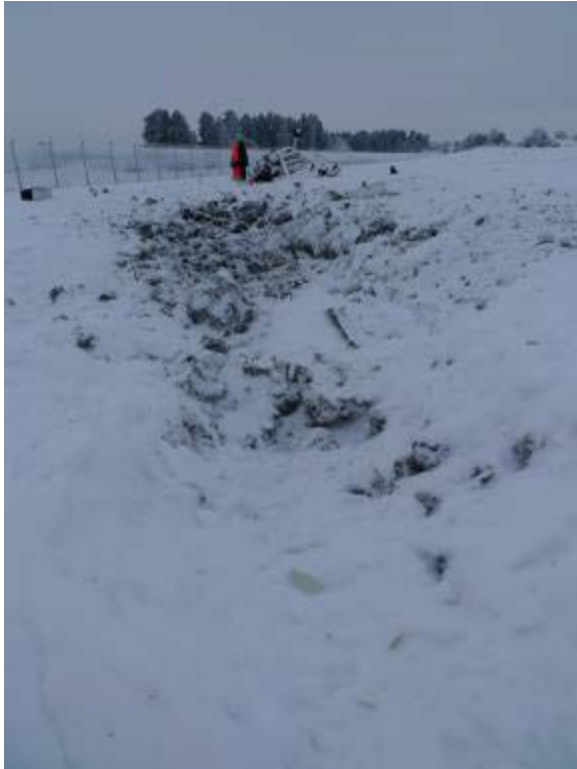
Figur 3. Spåren av nedslaget tyder på att markkontakt skett under vänstersväng med måttlig dykvinkel.
