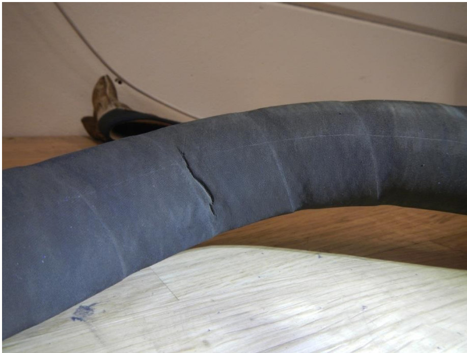
Figur 5. I slangmaterialet som undersökts finns ett veck i ytan.
