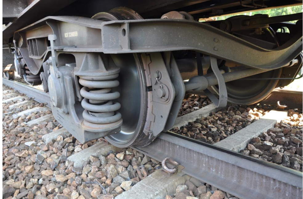
Figur 9. Första urspårade axel (axel 3 vagn 4). Obs hjulens position nära rälerna; befästningarna längs rälerernas högersidor är nästan alla borttryckta ända från urspåringsplatsen.
