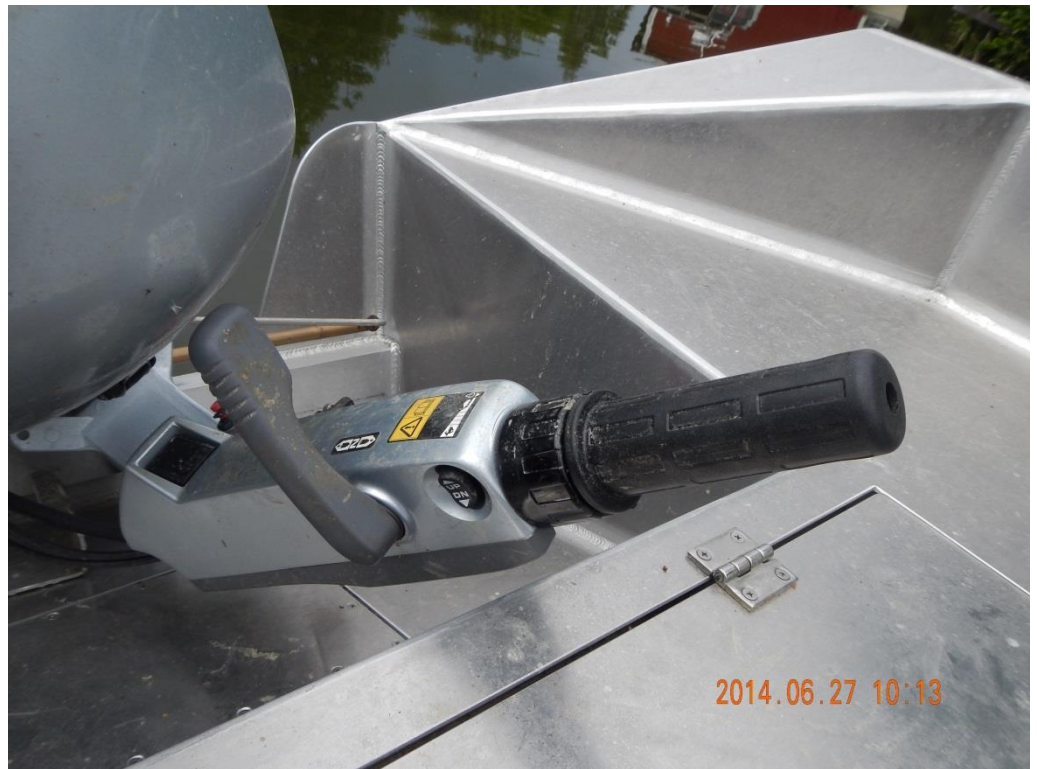
Figur 4. Rorkulten (styrspaken). Den svarta änden är gashandtaget, vid vars fäste friktionsskraven finns.
