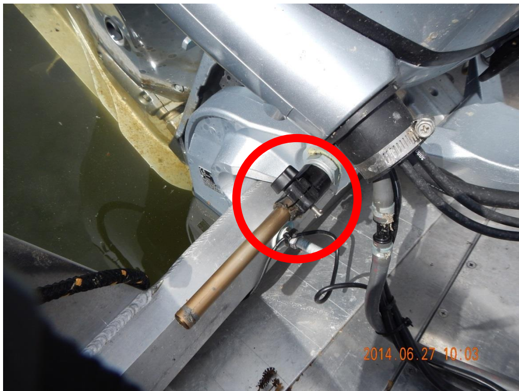
Figur 5. Friktionsskruv för styrning, markerad med röd cirkel. Skruven är av plast.
