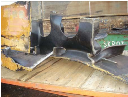
Bortskuren skadad plåt
