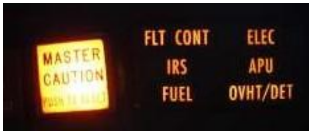
Fig. 3. Varnings- och annonseringspanel på instrumentpanelen framför vänster förare.
