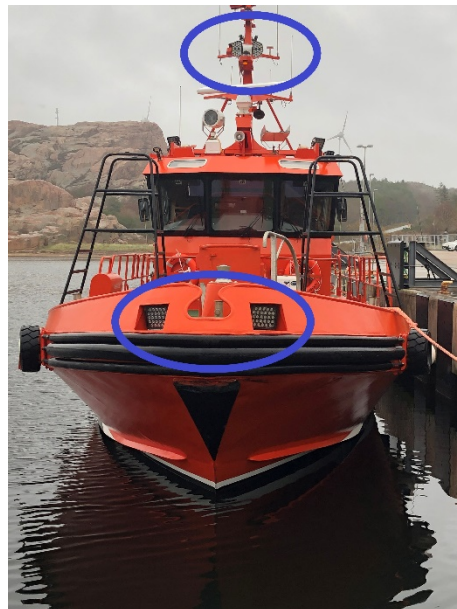
Bild 13. Nyinstallerade högt monterade sökarljus och strålkastare i bogen. Bild: Sjöfartsverket.
