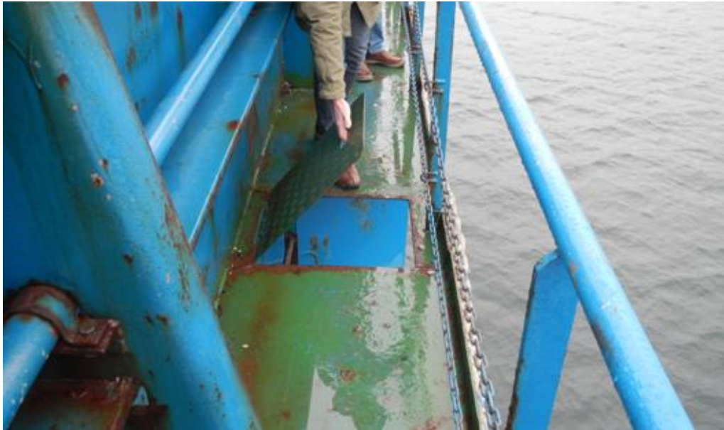
Figur 9 - Lucka ner till förtöjningspollare i styrbords brädgång.
