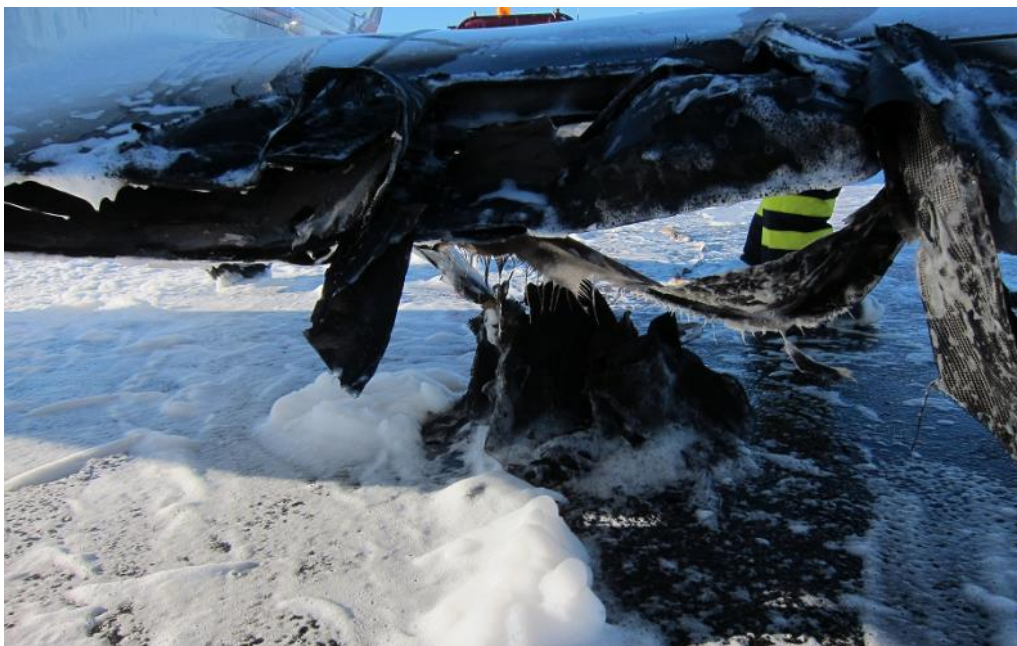
Fig. 3. Skador på hjul, vinge och klaff. Foto: Räddningstjänsten Borlänge.
