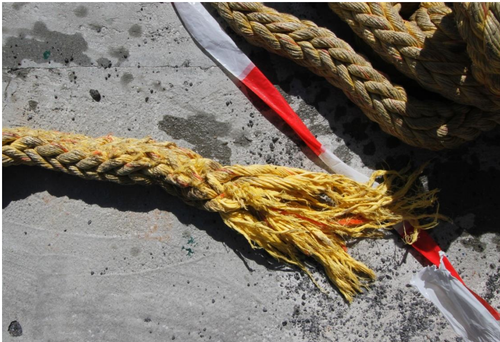
Bild 8. Den del av den brustna linan som låg på kajen.
