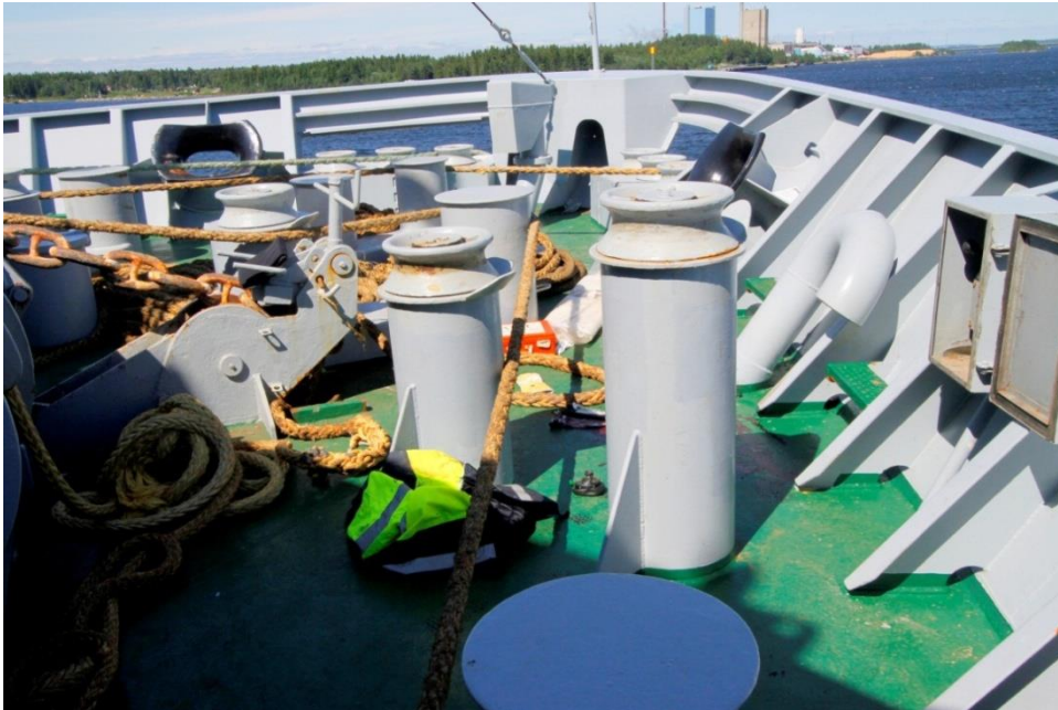
Bild 6. Fördäck. Till höger: den position som överstyrmannen stod i när olyckan inträffade i plattformsområdet vid manöverboxen. Till vänster: resten av det brustna förspringet, upprullad vid vinschtrumman. Observera att den konfiguration av trossarna som visas på bilden gjordes för att förtöja fartyget efter olyckan och visar därmed inte den konfiguration som vanligtvis används.
