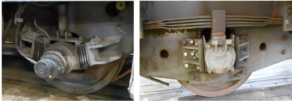
Figur 5. Lokets primärfjädring a) före ombyggnaden med chevroner och vertikaldämpare, och b) efter ombyggnaden med bladfjäderupphängning.
