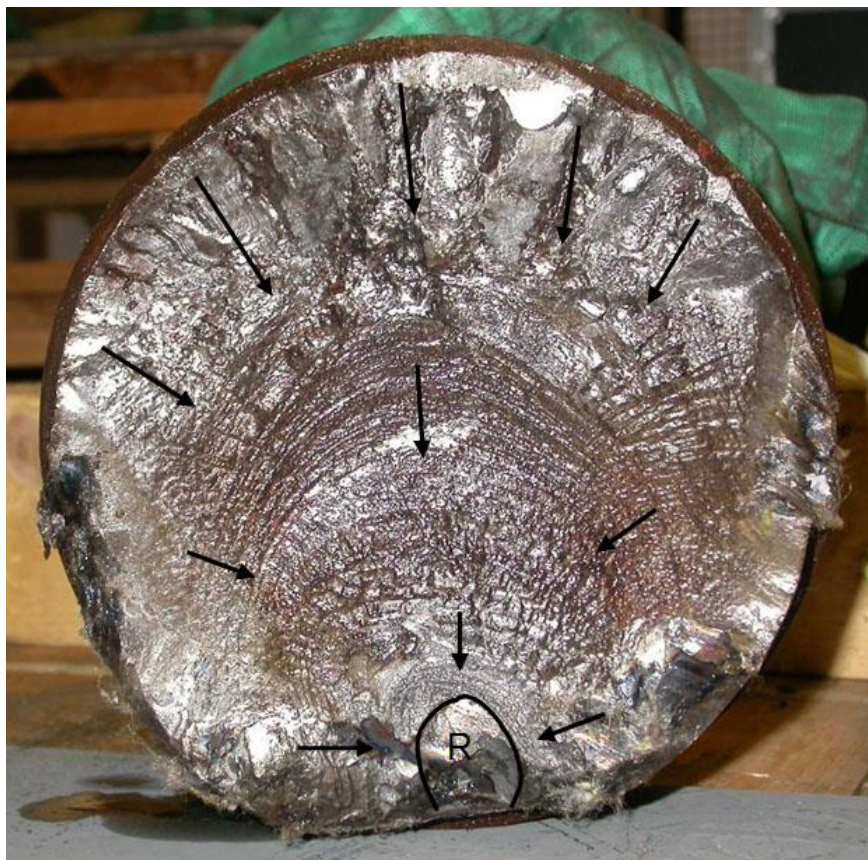
Figur 6. Bild på den skadade hjulaxeln. Utmattningen har startat högst upp i bilden (kl. 12) och har fortplantat sig i pilarnas riktning. Restbrottet har i bilden markerats med ett "R".
