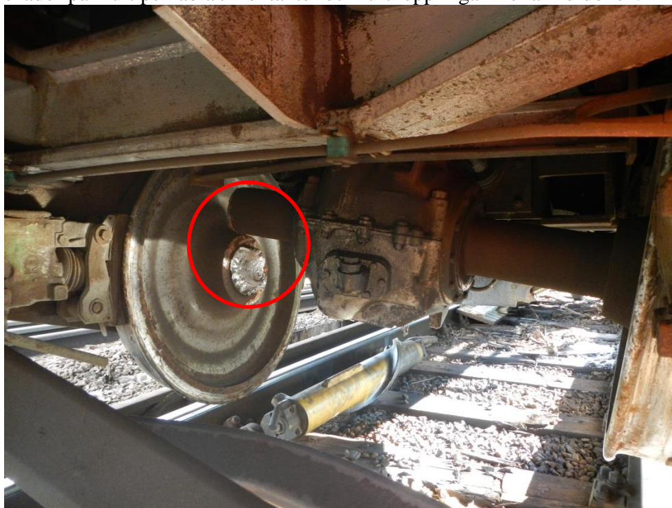
Figur 4. Bild på den brustna hjulaxeln.
