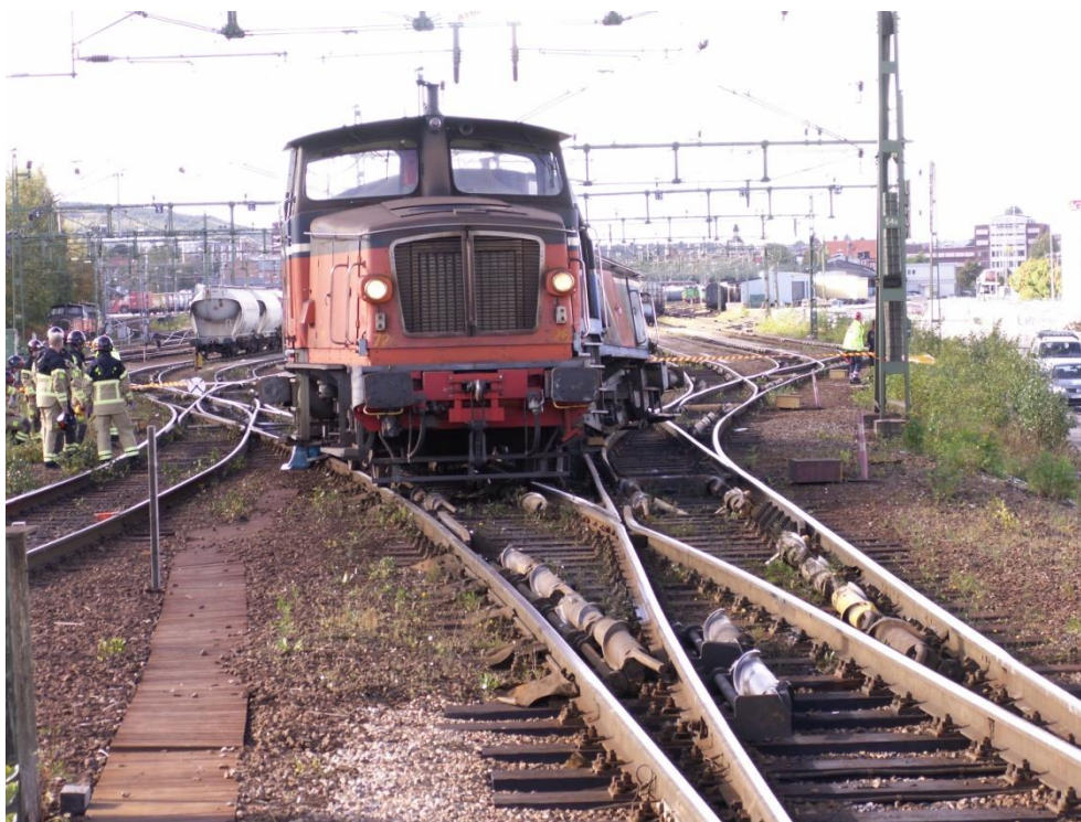
Figur 2. Bild på loket efter urspårningen men före bärgning. Foto Infranord.
