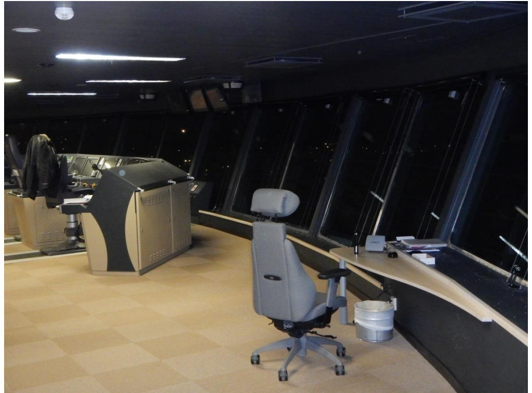
Figur 10. Utkikens (närmast) och navigatörernas platser på VIKING GRACE:s brygga. Av navigatörernas platser befinner sig befälhavarens längst bort, utanför bild.
