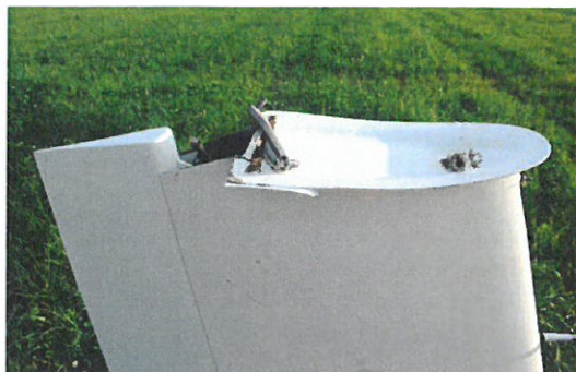
Figur 6. Fenan med skadad infästning för stabilisatorn. Foto: Jerry Isaksson.
