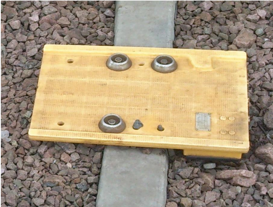
Figur 7. Hel balis med fästbrickor kvar (en bricka saknas).
