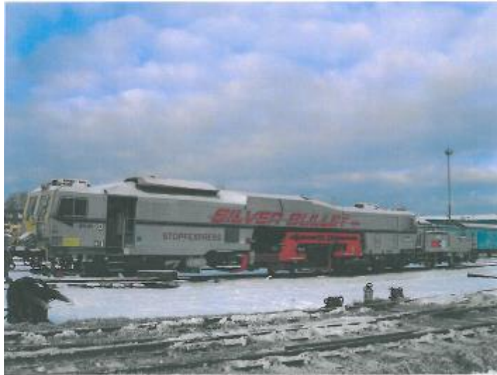
Figur 2. Bild på den spårriktare som användes vid underhållsspårriktningen mellan den 7 och 8 maj. Foto: Strukton Rail AB.
