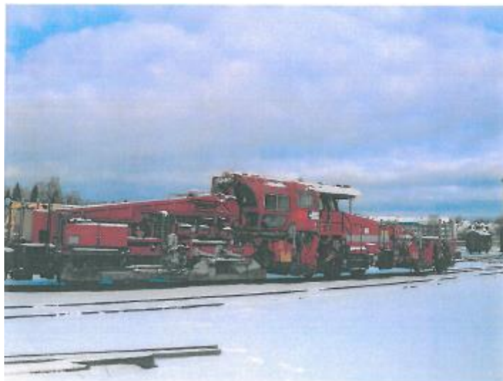
Figur 3. Bild på den ballastplog som användes vid makadamplogningen mellan den 7 och 8 maj. Foto: Strukton Rail AB.
