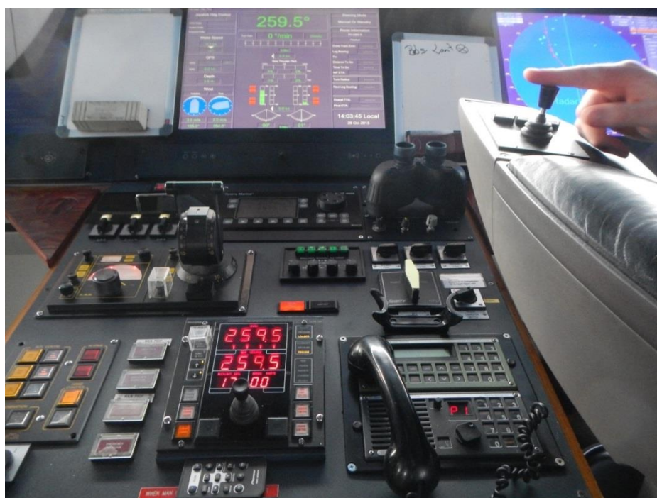
Fig. 8. Pulpeten mellan navigatörsstolarna på STENA JUTLANDICA. Till höger, mellan kikaren och VHF-luren, syns det med fluorescerande tejp märkta vredet till override-styrningen (se även fig. 10). Fingret uppe i högra hörnet vilar på den spak till automatstyrningen som användes vid tillfället.
