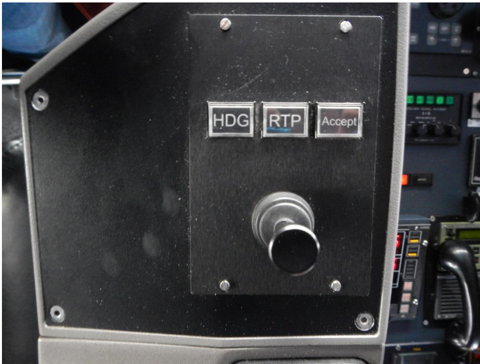
Fig. 9. Spak till automatstyrningen som användes på STENA JUTLANDICA, belägen på armstödet på en av navigatörsstolarna.
