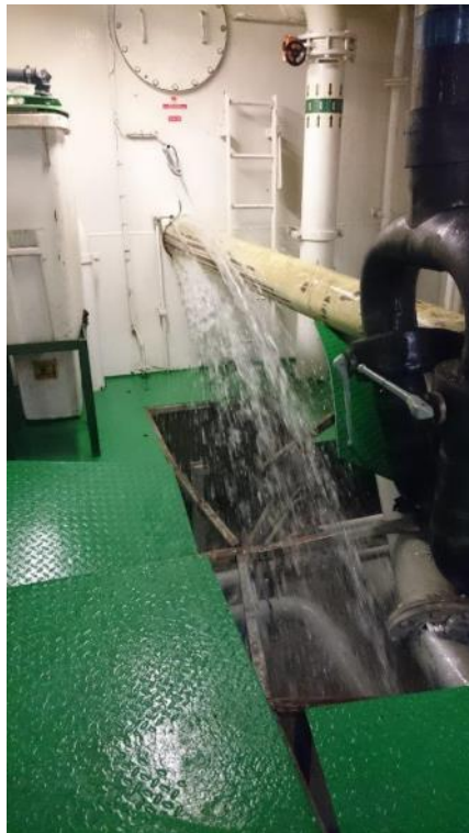
Fig. 4a och 4b. Vattenläckage i pumprummet på STENA JUTLANDICA. Bild: Stena Line.
