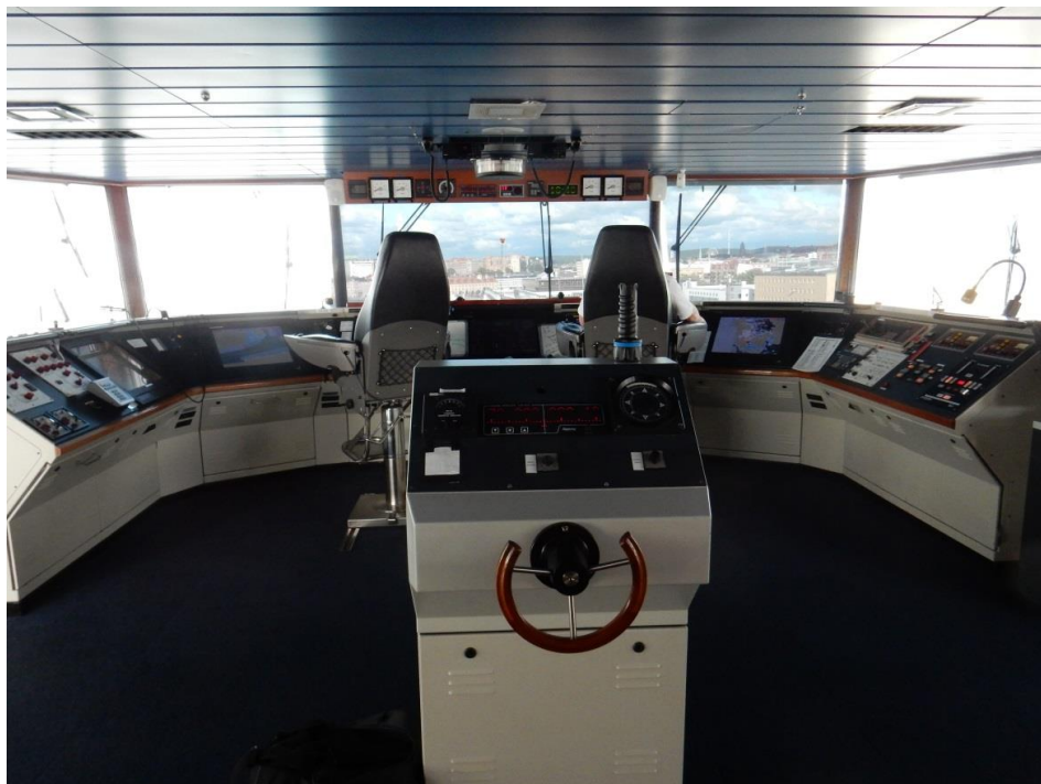
Fig. 7. Bryggan på STENA JUTLANDICA. I förgrunden, mitt på bilden, syns pulpeten där handstyrningen sker. Under däck (i taket) mellan stolarna syns roderindikatorn.
