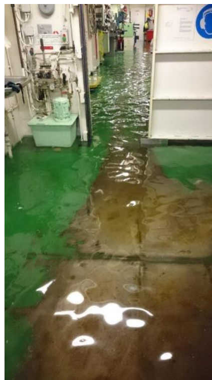
Fig. 4a och 4b. Vattenläckage i pumprummet på STENA JUTLANDICA. Bild: Stena Line.
