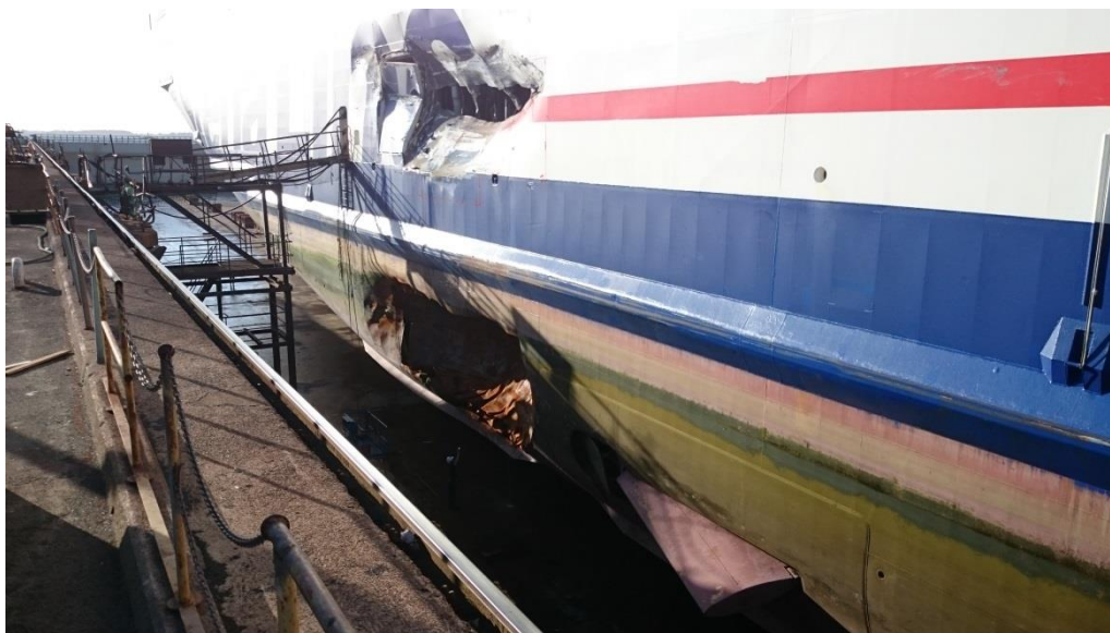
Fig. 5. Skador på STENA JUTLANDICA. Bilden är tagen i torrdocka. Bild: Termtank.
