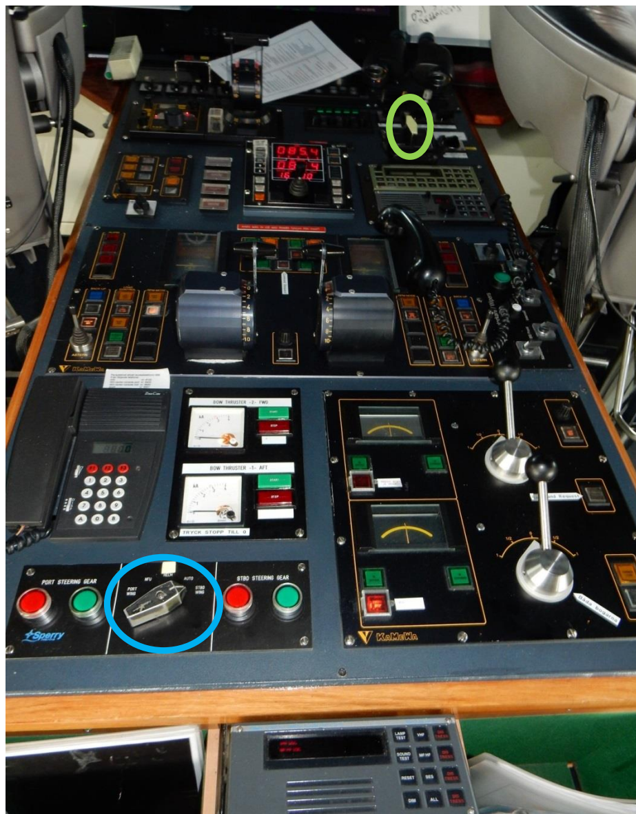
Fig. 10. Pulpeten mellan navigatörsstolarna på STENA JUTLANDICA. Override-vredet är placerat nära styrmans stol, inringat med grönt (uppe tillhöger i bild). Omkopplingen mellan olika sätt att styra fartyget finns på aktra änden av panelen, inringat med blått (nere till vänster i bild).
