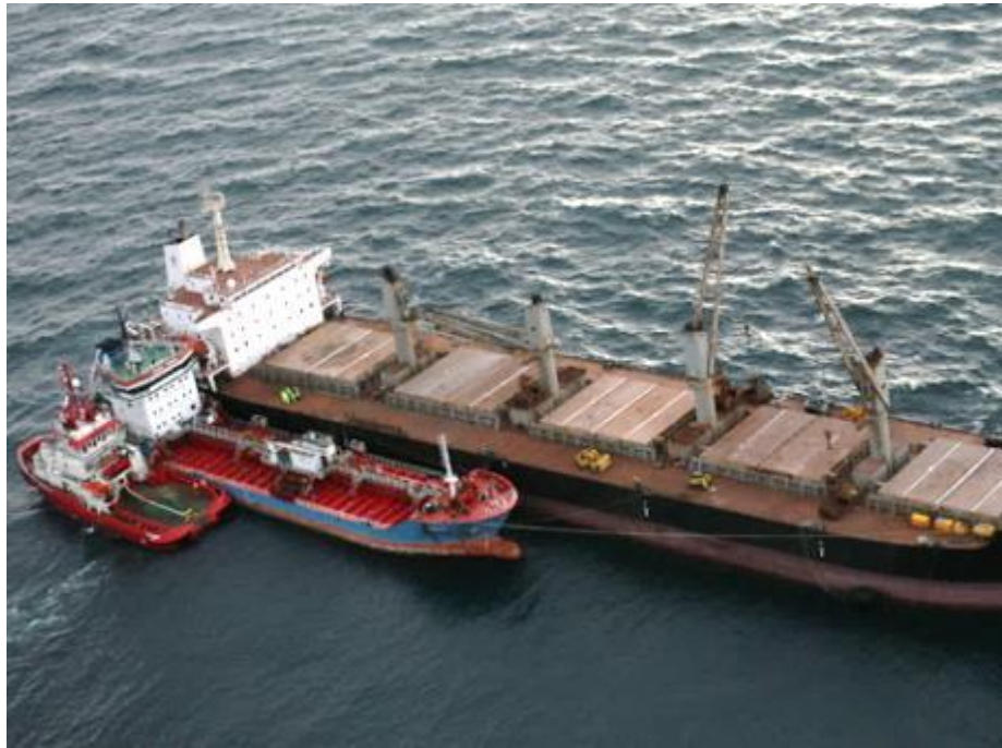
Figur 14. VICTORIA läkrar bunkerolja till LEON. Bild: Kustbevakningen.
