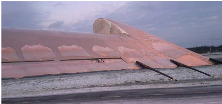
Figur 4. Höger skevroder efter händelsen. Foto: Aviator.
