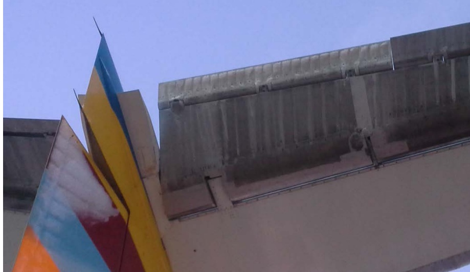
Figur 3. Höger höjdroder samt höger sida av sidrodret. Foto: Aviator.
