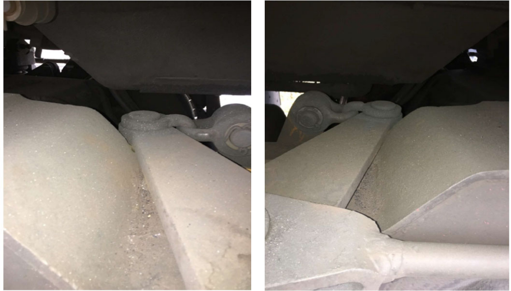
Figur 8. Bromsbommens rörelse förhindras av ramverk i boogien. Foto: Railcare T AB.
