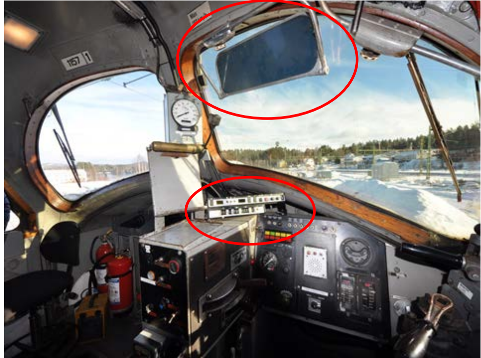
Figur 9. TMY-loket. Fotot taget i samband med platsbesök i februari 2017. Inringat i figuren är solskydd och ATC-panel.
