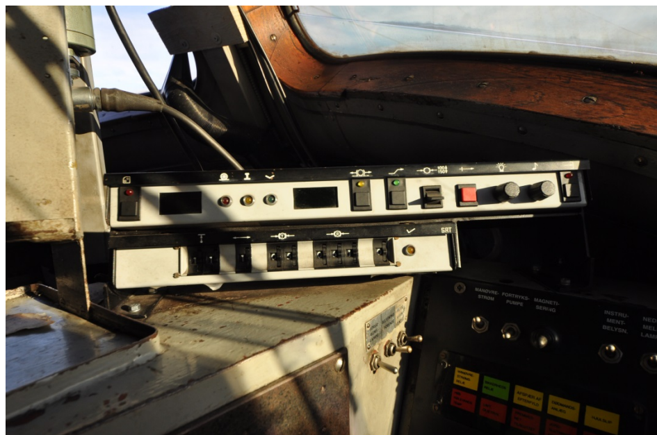
Figur 4. ATC-panelen med bland annat displayer (för- och huvudindikator) för visuella besked, varningslampor och ljud- och ljusreglage i övre raden samt tumhjul för inställning av hastighet, längd, bromstillställningstid, retardation och kurvöverskridande i nedre raden.
