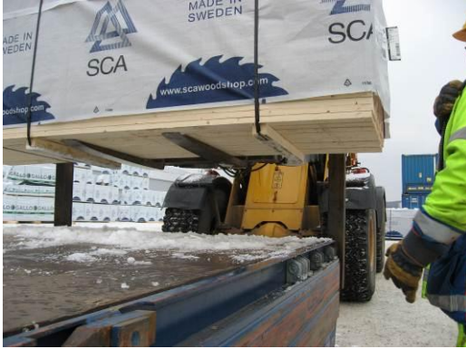
Figur 31 Virkespaket som lastas på målad stålplåt
