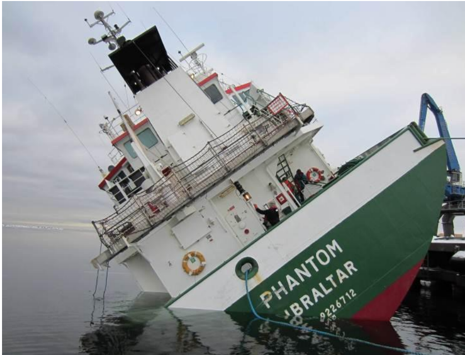
Figur 30 Fartygets slagsida cirka 40 grader till kaj i Oskarshamn. Foto:Kustbevakningen
