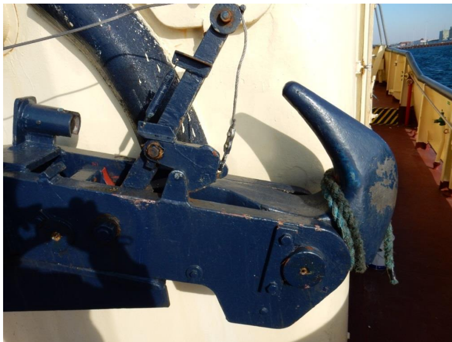
Figur 8. Krok med nödutlösning ombord på BONDEN.
