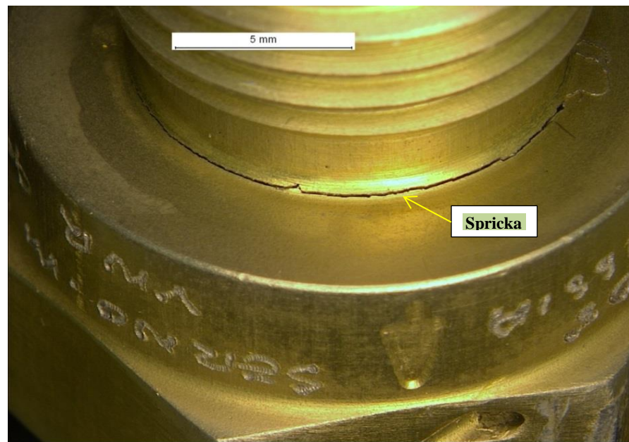
Figur 3. Förstorad detalj från backventilen med sprickan. Foto: Exova.
