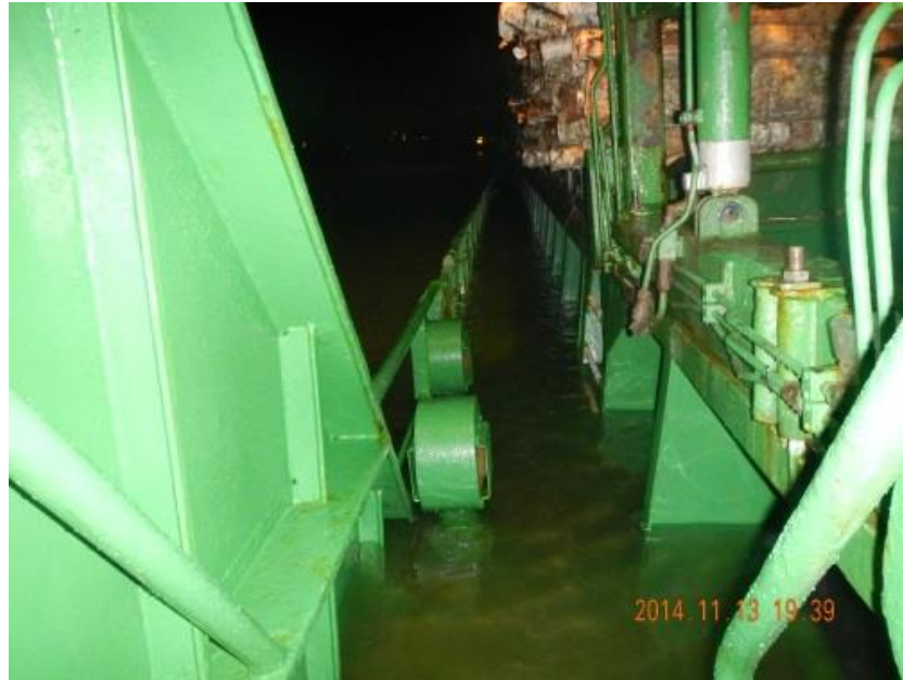
Figur 2. Babords huvuddäck under vatten.
