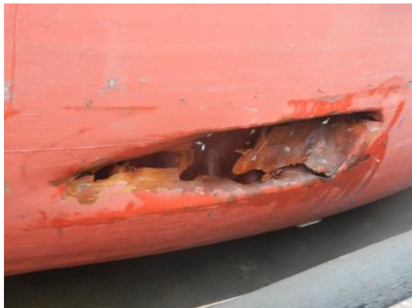
Figur 3. Bottenskada 4x1 meter. Foto Thun.
