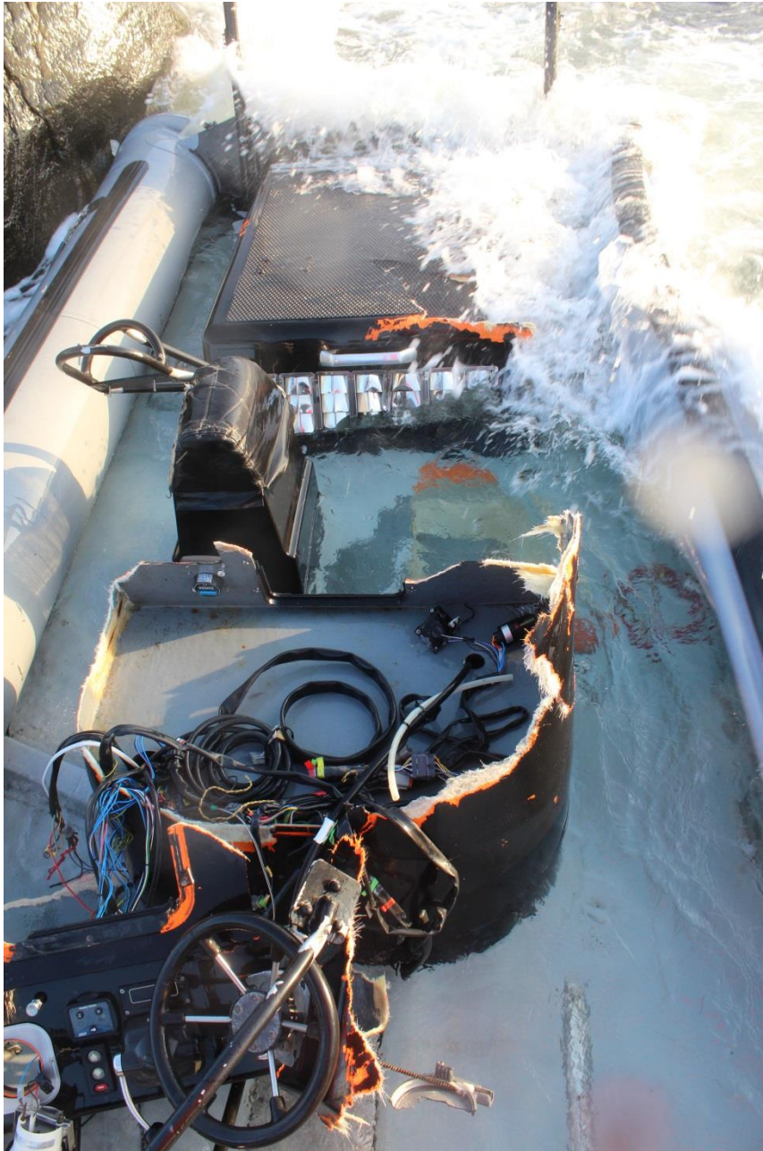
Fig. 5. RIB:en sedd förifrån, innan bärgning. På bilden syns styrepulpeten som brutits sönder och tryckts föröver i samband med kollisionen, likaså syns styrbordsstolen vars ryggstöd pressats föröver. Babordsstolen (förarstolen) hade brutits loss från sitt fäste i däcket och saknas på bilden. Bild: KBV.
