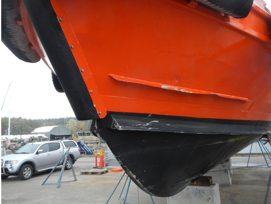
Fig. 4. Skrapmärken på lotsbåtens babordssida. Längst ner på stävgummit syns också rester av glasfiberarmerad plast och färg från RIB:en.
