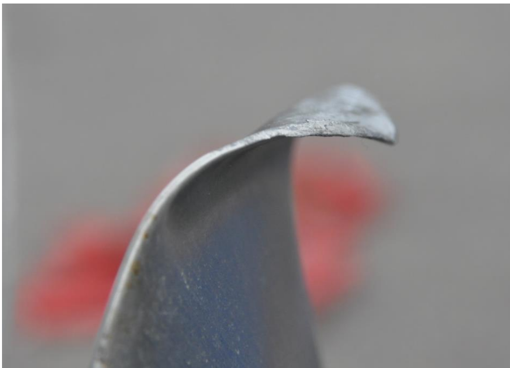
Fig. 13. Skada på propellerblad, som bedöms ha uppstått under gång.
