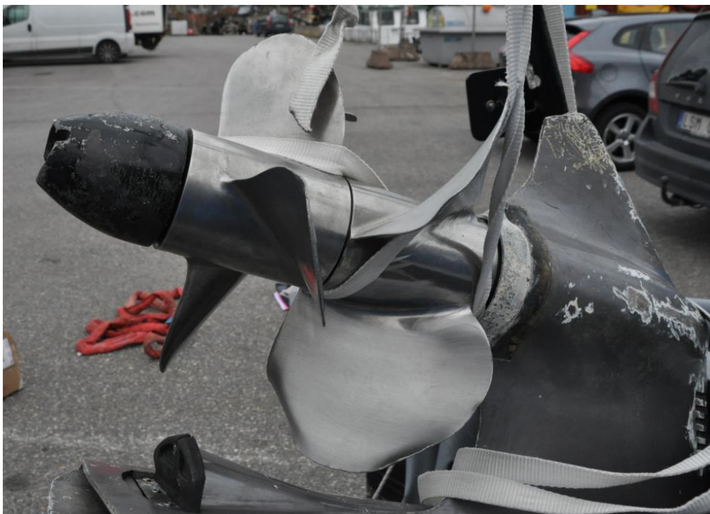
Fig. 12. De skadade propellrarna på RIB Delta.
