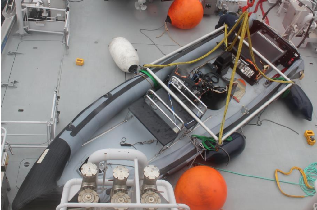
Fig.14. RIB:en efter bärgning. Här syns bl.a. de oskadade ryggstöden för om styrpulpeten och den oskadade bågen längst akterut. Bild: KBV.
