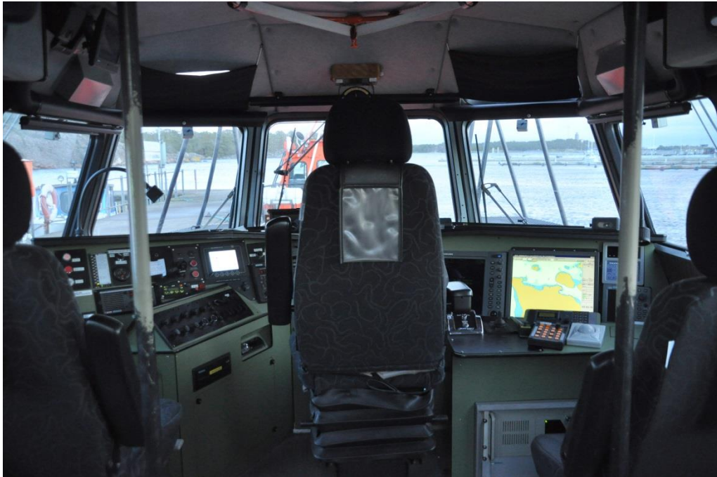
Fig. 7. Bryggkonsolen på PILOT 116 SE sedd akterifrån. Den ljusa skärmen till höger i bild är det elektroniska sjökortet. Direkt till vänster om detta syns den vid fototillfället nedsläckta radarskärmen.
