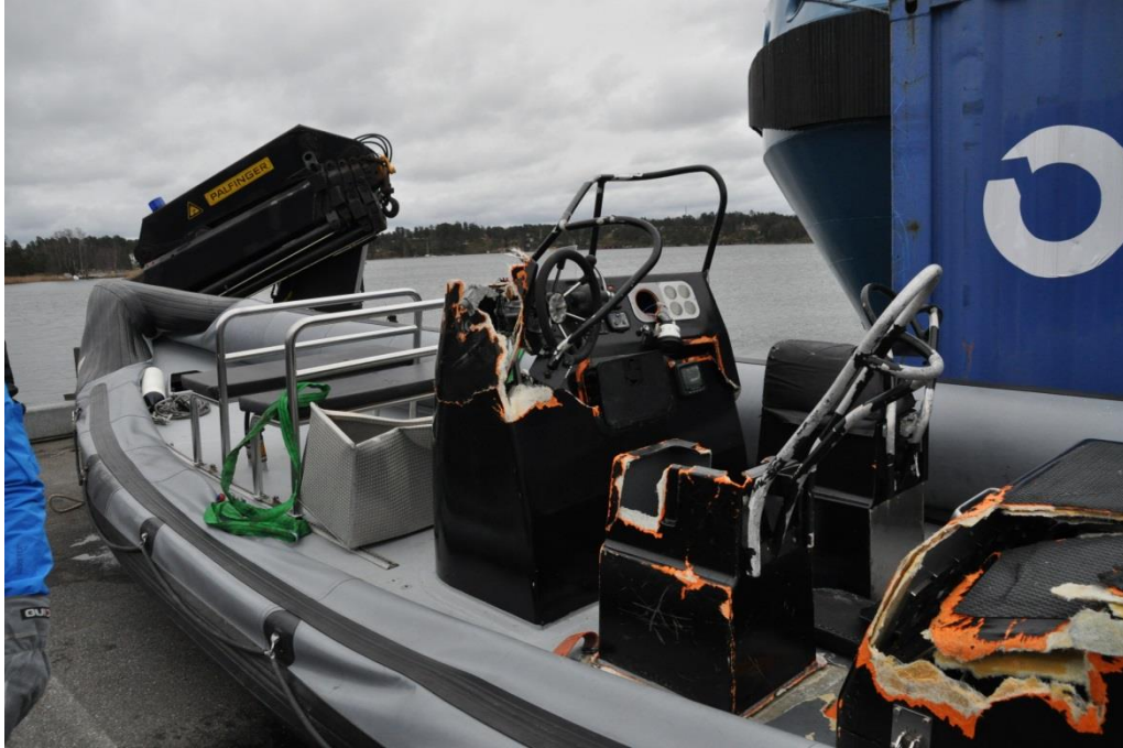
Fig. 6. RIB:en efter bärgning. Styrpulpeten, som brutits sönder, är nu återplacerad. För om denna, något till vänster i bild, syns den aluminiumlåda som skadats av den framtryckta styrpulpeten. Likaså är babordsstolen åter på plats, och det syns tydligt var lotsbåtens stäv träffat denna och att ryggstödet tryckts akterut och skadat maskinkappen.
