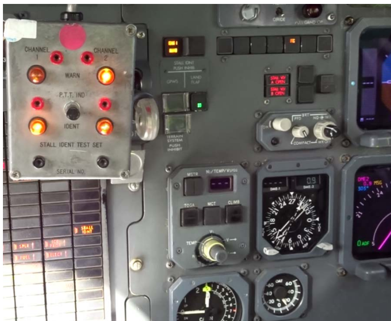
Figur 13. Indikeringar på instrumentpanelen samt testutrustning, vid stick push.
