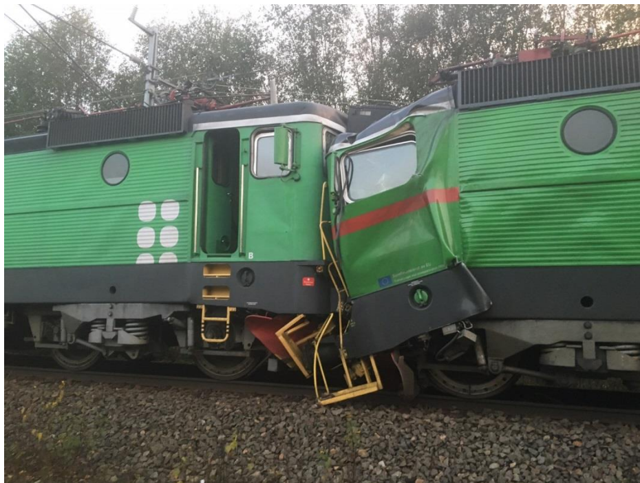
Figur 3. Loken på tåg 9207 och 6032 som kolliderat. Foto: Anders Eriksson, Strukton Rail AB, olycksplatsansvarig för Trafikverket.
