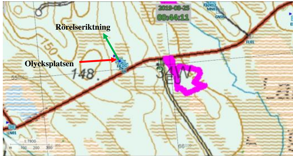
Figur 2. Skärmdump från registrerad data i systemet för strids träningsanläggning, STA. Symbolerna vid den röda pilen visar läget för de tre stridsfordonen och den gröna pilen visar deras rörelseriktning vid tiden för olyckan. Den rödsvarta markeringen är väg 356. Källa: Försvarmakten.
