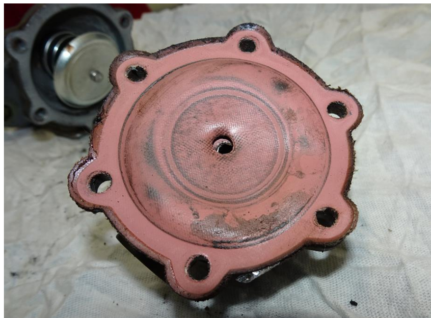
Figur 12. Närmast i bild syns membranet med den yttre halvan av bränslepumphuset. I bakgrunden syns den andra halvan av bränslepumphuset med den ena plattan som ska driva membranet.
