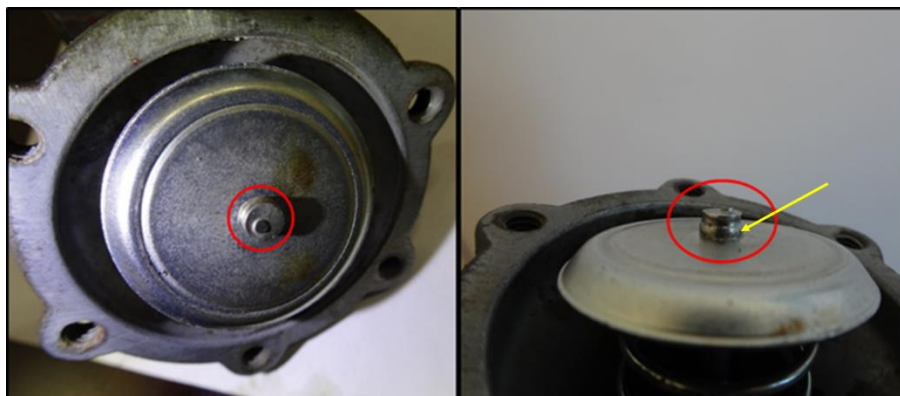
Figur 13. På bilden syns den inre plattan som är en del av drivningen av membranet. I mitten av plattan syns den del som ska hålla ihop plattorna och membranet, skaftet och det stukade huvudet (nitskallen). På den högra bilden syns det svullnade skaftet, markerad med gul pil.
