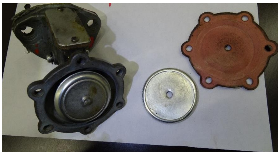
Figur 14. Del av bränslepumpen med den lösa drivplattan och membranet.
