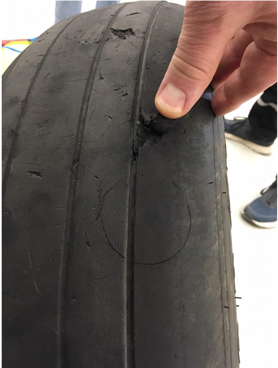
Figur 3. Däckskador fotograferade efter landning på Göteborg/Landvetter flygplats. Det runda märket passar formen på den trasiga banljusdelen. Foto: Saab AB.
