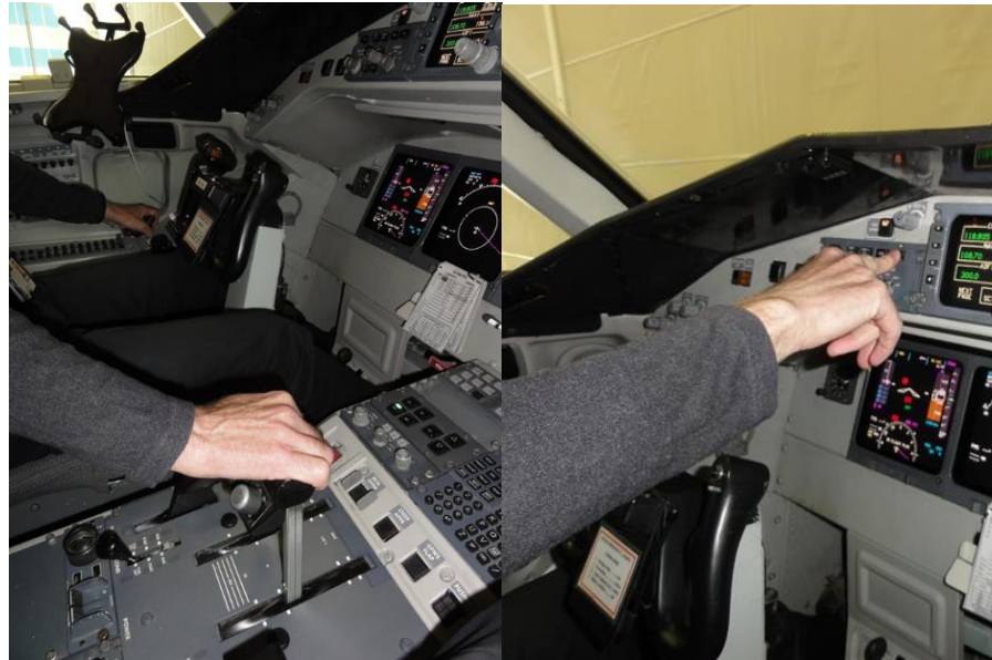
Figur 14. Pilotens handhavande under en rekonstruktion av händelsen i flygplanet. Till vänster ses händerna under propellertest och till höger vid tidtagning precis vid början av startrollningen.
