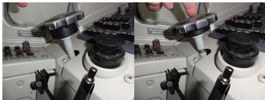
Figur 8. Ratten till noshjulsstyrningen i avaktiverat läge till vänster och i aktiverat läge till höger.
