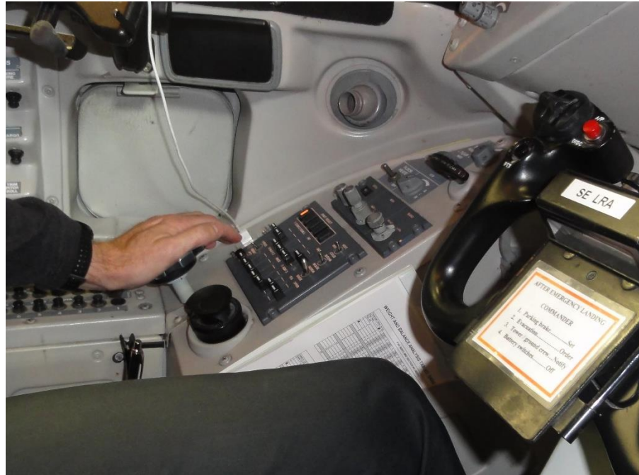
Figur 7. Piloten trycker ned ratten för att aktivera noshjulsstyrningen.
