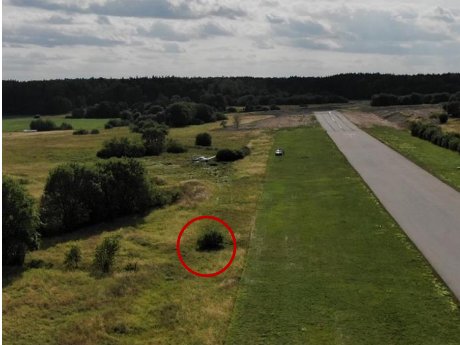
Figur 7. Det markerade buskaget inritat av SHK hade islagsmärken efter flygplanet, som syns i bakgrunden. Foto: SHK. Publicerat med tillstånd från Lantmäteriet.
